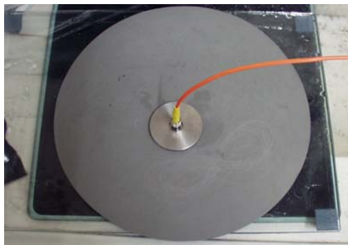
Figura 7.37. Processo de polimento do conector de fibra óptica.
