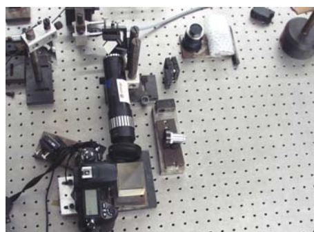
Figura 8.6. Sistema de holografia digital com câmara fotográfica.
