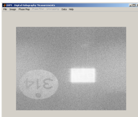
Figura 8. Ajuste da distância por focagem do objecto.
