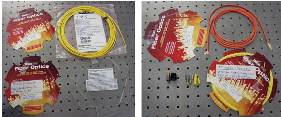
Figura 7.29. Diferentes tipos de fibra óptica; cabos de protecção e conectores.
