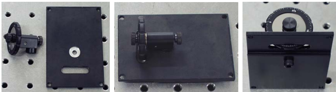
Figura 7.8. Montagem do filtro de atenuação e acesso exterior
