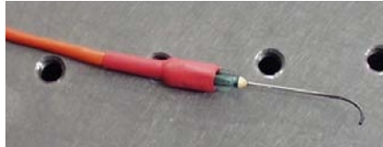
Figura 7.35. Implementação da ponta de fibra óptica que vai iluminar o sensor CCD.
