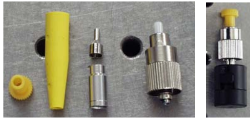
Figura 7.32. Tipos de conectores utilizados. Conector definitivo e temporário.
