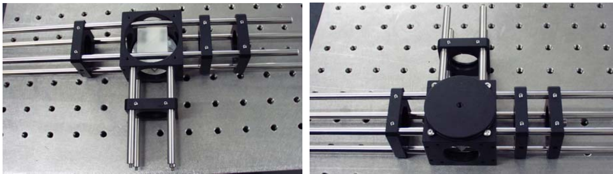
Figura 7.49. Montagem do cubo divisor de feixe no sistema modular opto-mecânico.
