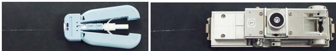
Figura 7.34. Descarnagem e corte de uma das extremidades da fibra óptica.
