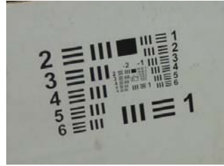
Figura 4.29. Padrão de calibração usado na focagem da imagem
