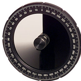
Figura 7.7. Filtro de variação contínua montado numa escala angular.
