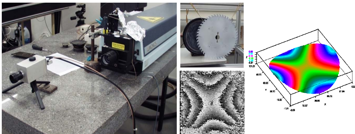
Figura 4.15. Análise modal de uma serra circular por dupla exposição.
