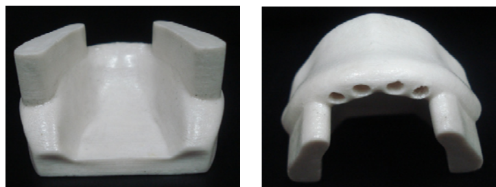
Figura 8.38. Modelo da maxila obtido por maquinagem.
