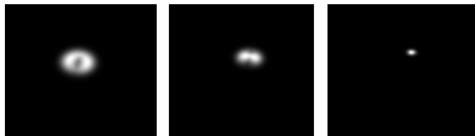
Figura 4.14: Matriz de localização com uma resolução 6 de 0.25 m/pixel para o iBeacon com Minor 64416 aos instantes 10, 230 e 460 s.
