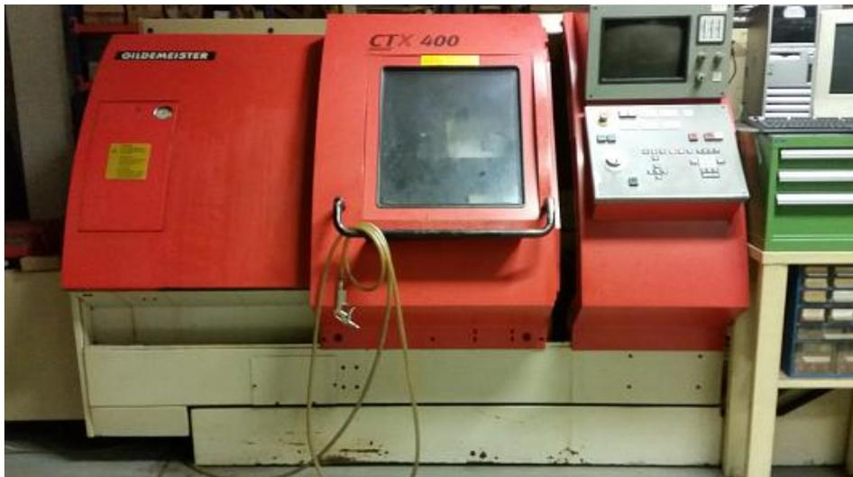
Figura 71 - Torno CNC GILDEMEISTER CTX 400 utilizado nos ensaios de maquinagem.
