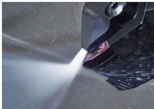
Figura 28 - Lubrificação aplicada a elevada pressão [41].
