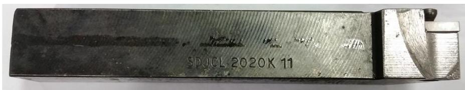
Figura 63 - Porta-ferramentas SECO SDJCL 2020K 11, utilizado em todo o procedimento experimental.
