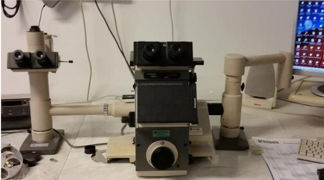
Figura 54 - Microscópio óptico *Olympus PMG 3* utilizado na análise microestrutural.
