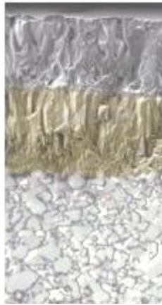
Figura 21 - Revestimento CVD de várias camadas, substrato na parte inferior e revestimentos na parte superior [37].
