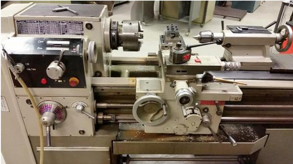
Figura 70 - Torno paralelo EFI DU20 utilizado nos ensaios instrumentados.
