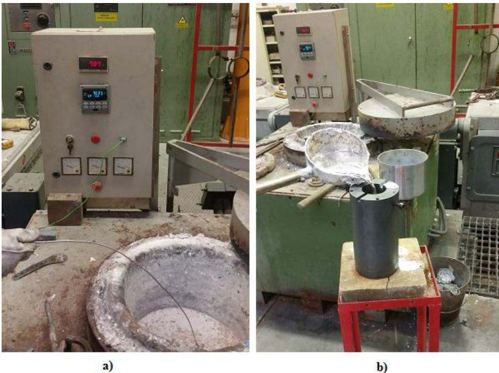
Figura 51 - Fusão e vazamento dos provetes de maquinagem: a) forno de resistências utilizado; b) vazamento manual em coquilha de cobre.
