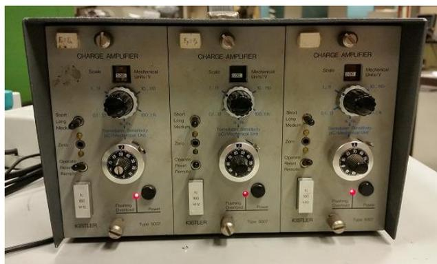
Figura 76 - Sistema de amplificação de sinal Kistler 5007 utilizado.
