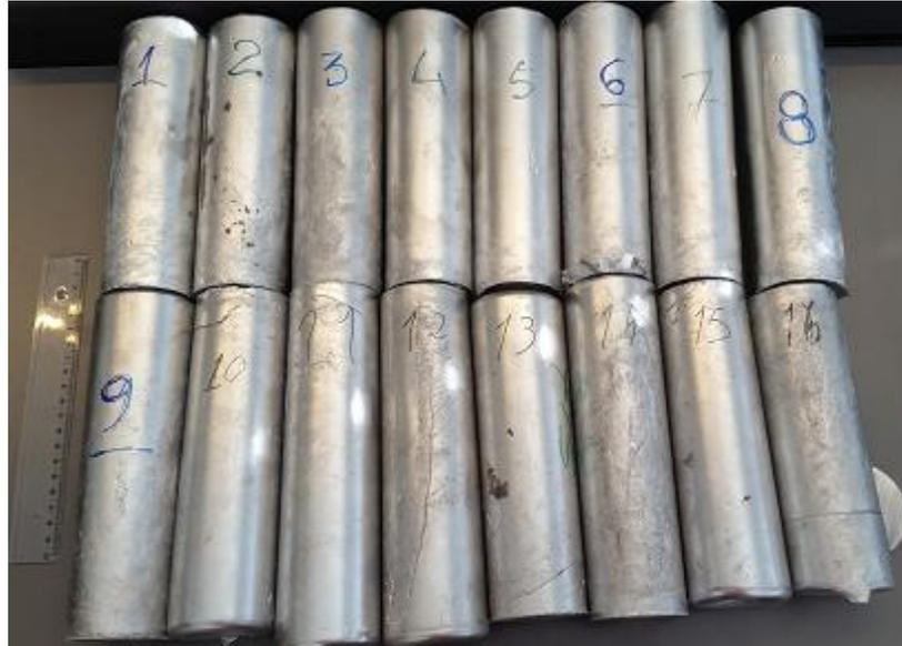
Figura 52 - Provetes (cilíndricos) em bruto de fundição.
