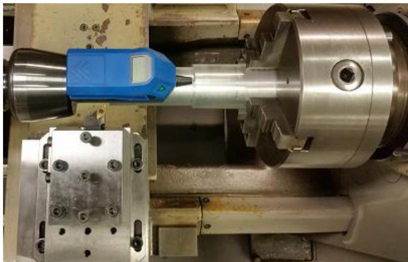
Figura 79 - Rugosímetro portátil *T500* utilizado para efetuar medições entre cada ensaio.
