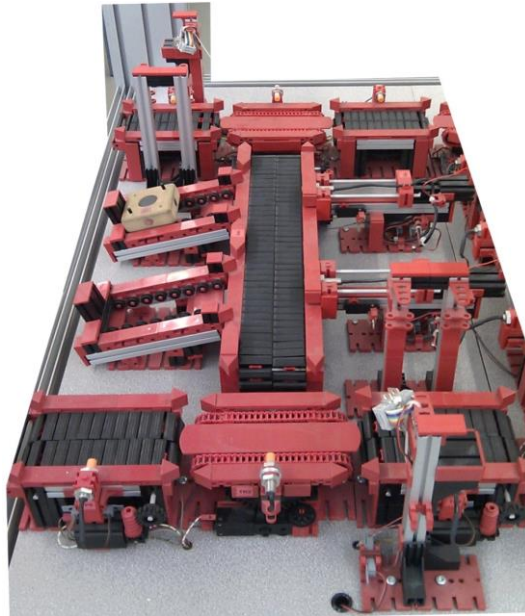
Figura 25 - Célula de cargas e descargas da linha de produção flexível [12]
