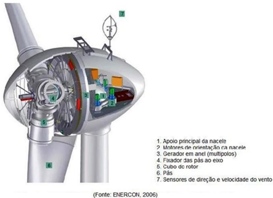
Figura 3.20: Diversos constituintes de um aerogerador.
