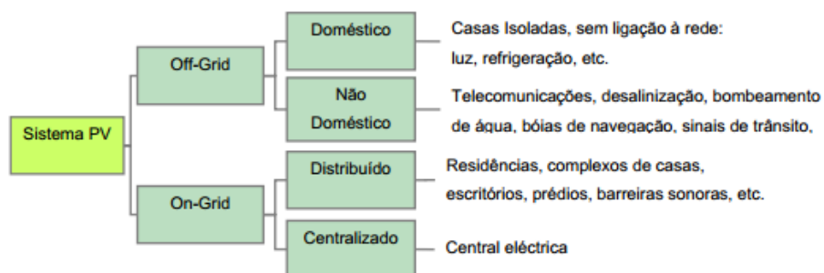
Figura 2.6: Tipos de sistemas fotovoltaicos e utilizações. [15]
