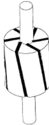
Figura 4.1: Configuração de um rotor com os ímãs permanentes inclinados. [57]
