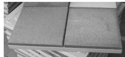
Figura 17 – Protótipo do pavimento com incorporação de PCMs [63].
