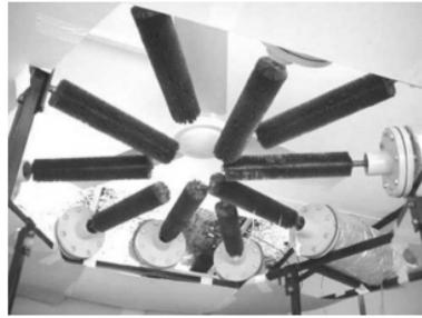
Figura 18 - Configuração dos tubos de calor embebidos em PCMs localizados por baixo da ventoinha [65].
