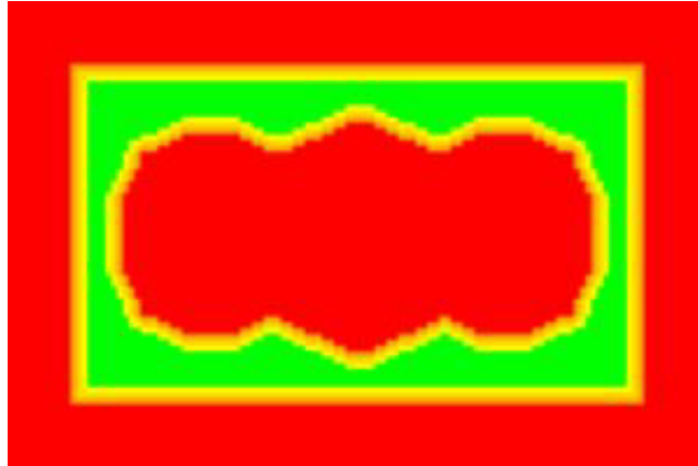
Figura 5.13: Mapa expandido com a presença do segundo robô na posição (X, Y) = (0, 0)
