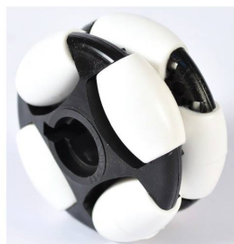
Figura 4.1: Roda omnidirecional usada da Bot'n Roll
