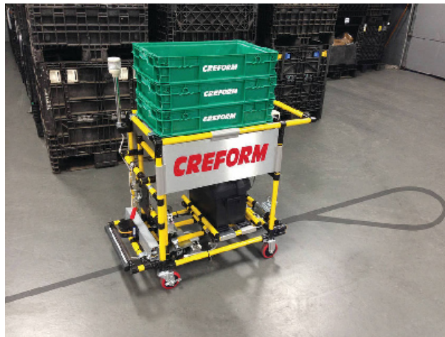
Figura 3.1: Exemplo de AGV de seguimento de linha
