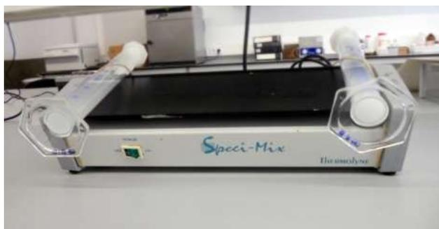
Figura 8 – Agitador mecânico *Speci-Mix* (*Thermolyne, USA*), agitação constante efetuada a 18 rpm com ângulo de oscilação de 1°-48°
