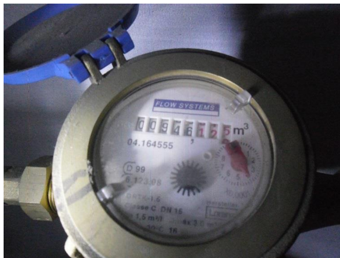
Fig. 4.55 - Leitura do contador após o corte do abastecimento de água do cliente XII.
