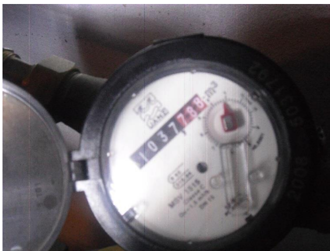
Fig. 4.53 - Leitura do contador após o corte do abastecimento de água do cliente XI.
