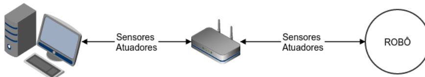
Figura 3.17: Programação Transparente - Diagrama de comunicação usado no EV3.
