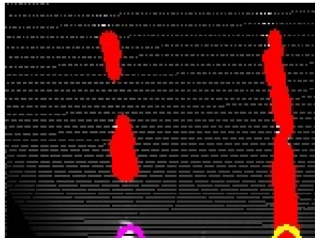
Figura 3.39: Deteção de linhas na imagem IPM. Linhas a vermelho são obtidas a partir da transformada de Hough . Os círculos amarelo e roxo mostram o ponto de tracking de linhas (central e da direita).
