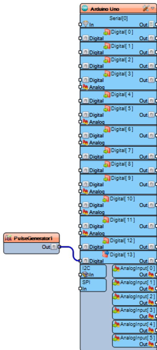
Figura 3.22: Visuino - exemplo de um LED a piscar.
