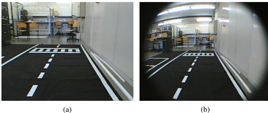
Figura 3.34: Foto tirada sem lente (a) e com lente (b).
