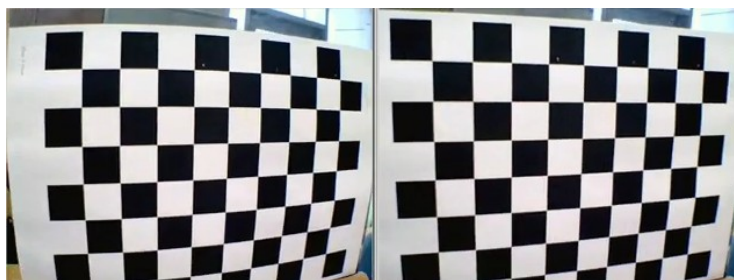
Figura 2.7: Exemplo de uma imagem distorcida (à esquerda) e remoção da distorção (à direita) [4].
