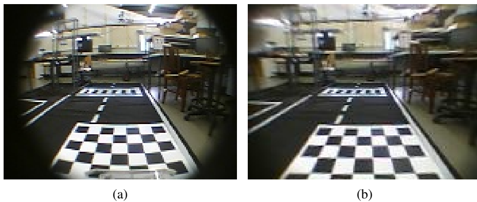
Figura 3.35: Foto tirada com lente (a) e remoção da distorção (b).
