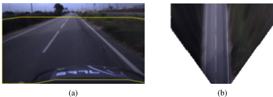
Figura 2.6: Imagem de entrada (a) e respetiva transformação IPM (b) adaptado de [3].
