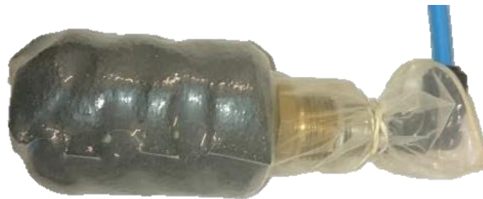
Figura 2.17 - Prova de conceito com EPDM de célula fechada e membrana de latex.
