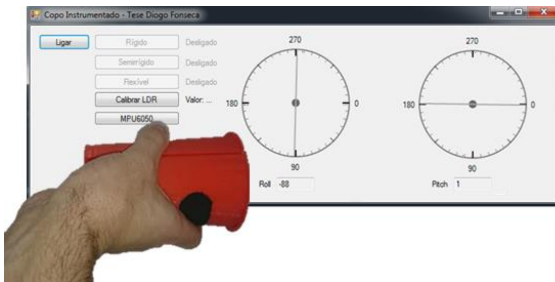
Figura 3.14 - Ambiente do programa com exemplo de rotação dos indicadores, em graus, que acompanham a movimentação do dispositivo real. No exemplo: Roll = -88^\circ ; Pitch = 1^\circ .
