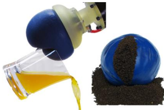
Figura 2.3 - Utilização de material granulado sob o efeito de vácuo para alteração/criação de forma/rigidez.
