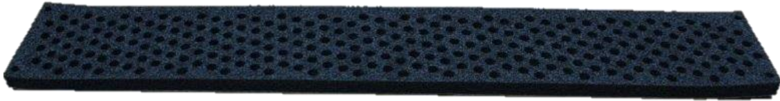
Figura 2.16 - EPDM de célula fechada e furos padronizados.
