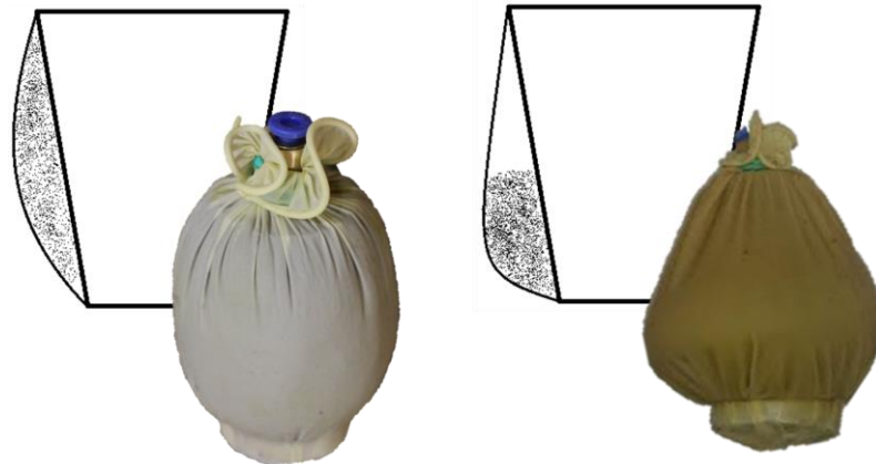
Figura 2.14 - À esquerda: Granulado distribuído uniformemente pela membrana; À direita: Força gravítica acumula o granulado no fundo da membrana.
