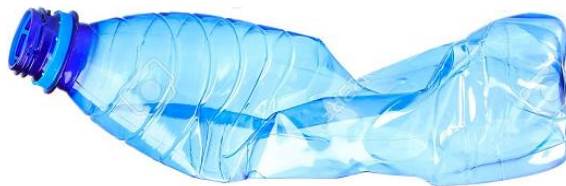
Figura 2.11 - Deformação plástica de uma garrafa após sujeita a uma pressão de vácuo.
