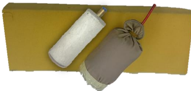
Figura 2.19 - Prova de conceito com Poliuretano: Núcleo de acrílico e cobertura com membrana de latex com espessura de 0.33 mm.
