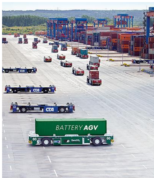
Figura 2 – Linha de AGVs no porto de Hamburgo [8]
