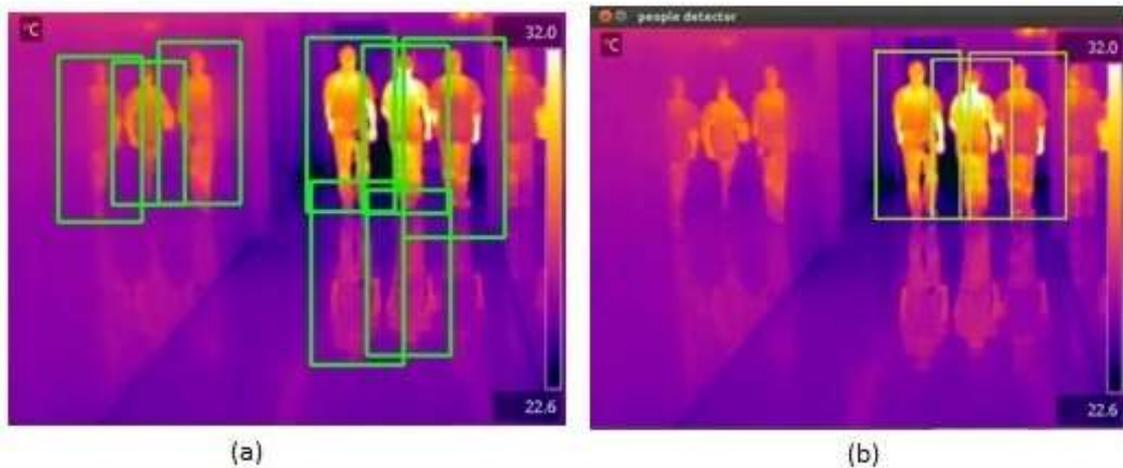
**Figura 5.8** - Exemplo de deteção sem filtro (a) e com filtro de pós-processamento (b).
