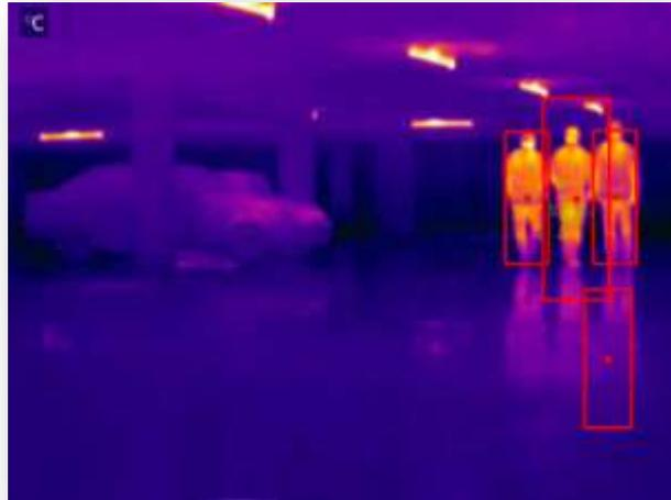
**Figura 5.6** - Exemplo de uma falsa deteção devido à presença de reflexões parciais provocados pelo espelhamento do corpo no pavimento.
