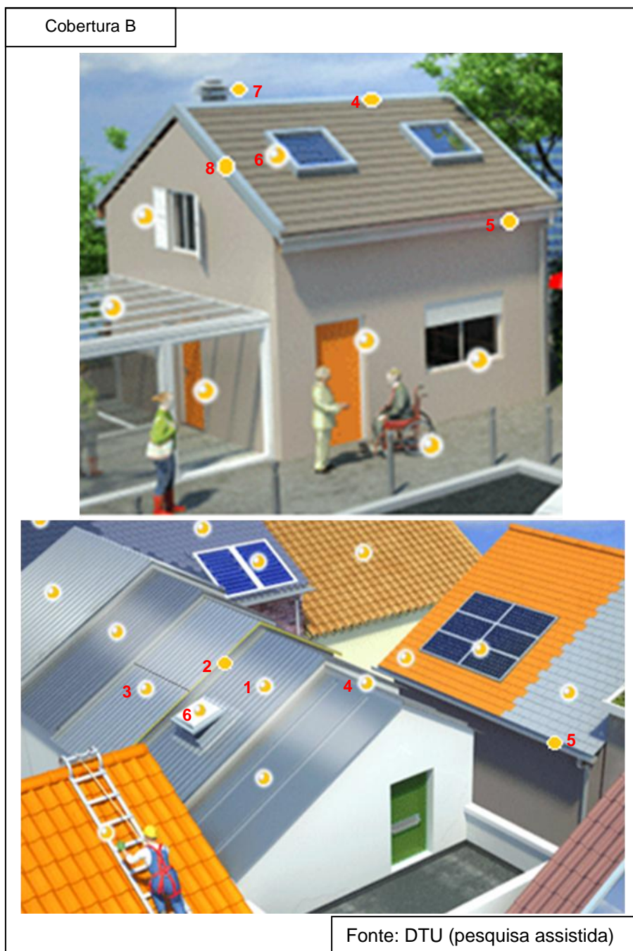
Fig.16 – Projeção em 3D de um edifício com cobertura inclinada em painel sandwich com identificação da zona corrente e respetivos pontos singulares
