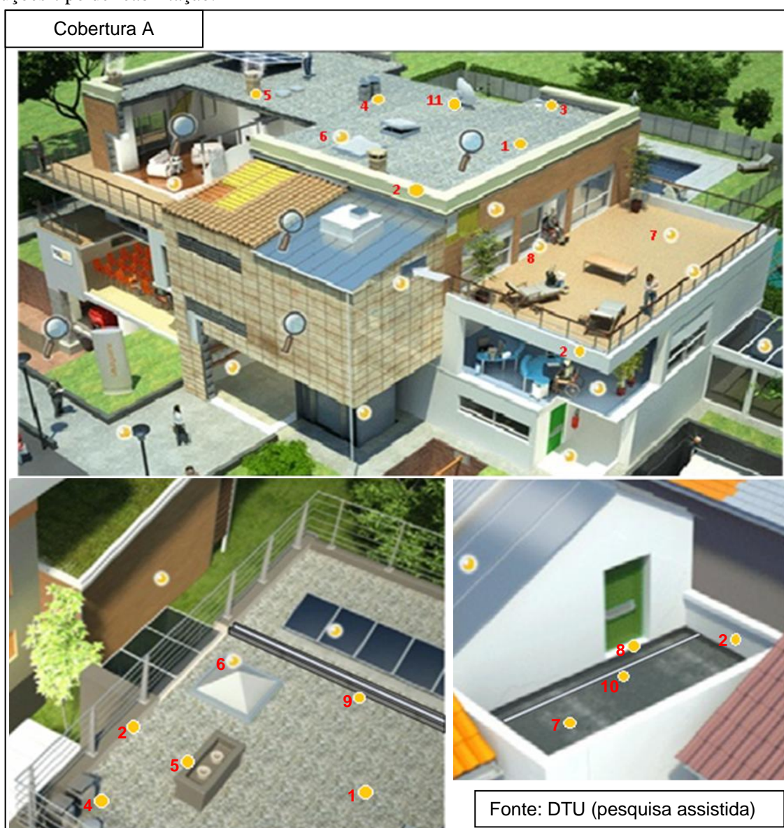
Fig.15 – Projeção em 3D de um edifício com cobertura em terraço acessível e não acessível com identificação da zona corrente e respetivos pontos singulares
