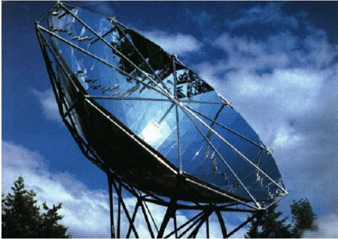
Figura 2-5 - Representação de um sistema de concentração solar de 2 eixos, de [25]
