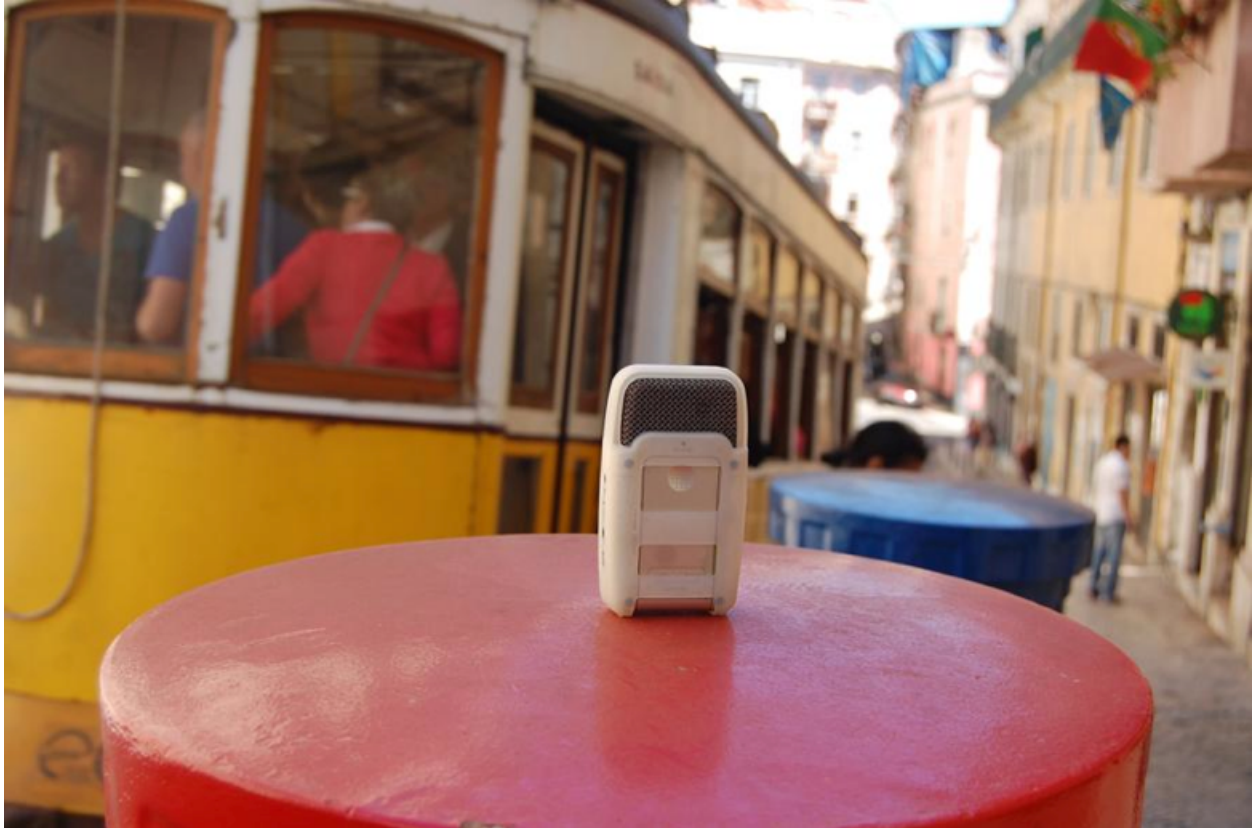
Fig. 2 - Gravador Zoom H2 utilizado nas gravações de campo
