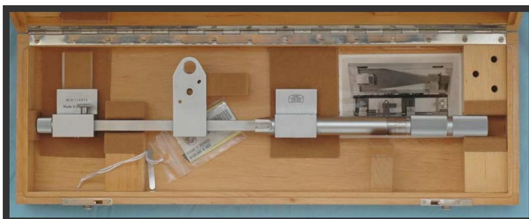
Figura II.3. Micrómetro *Carl Zeiss*<sup>®</sup>.
