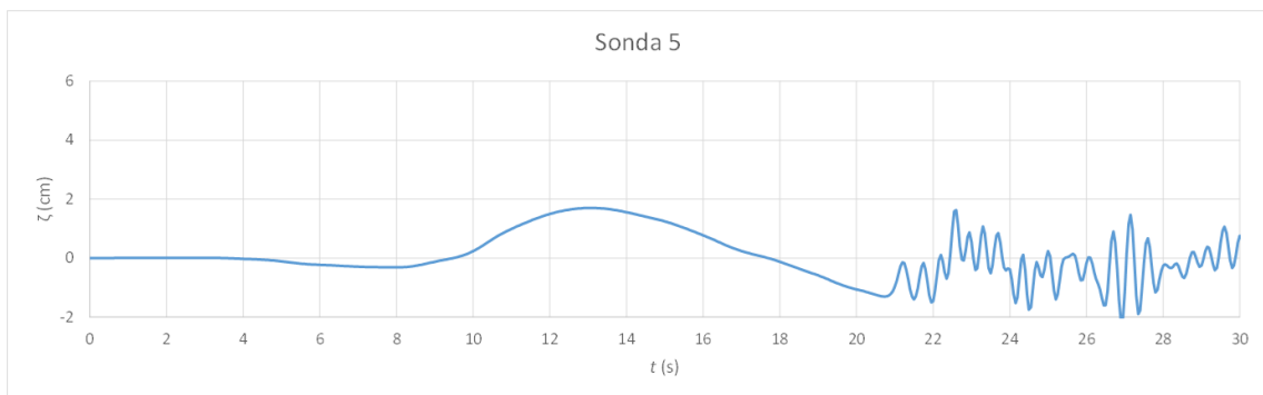
Figura 4.10 – Elevação da superfície livre na Sonda 5: (—) simulação com o SWASH.
