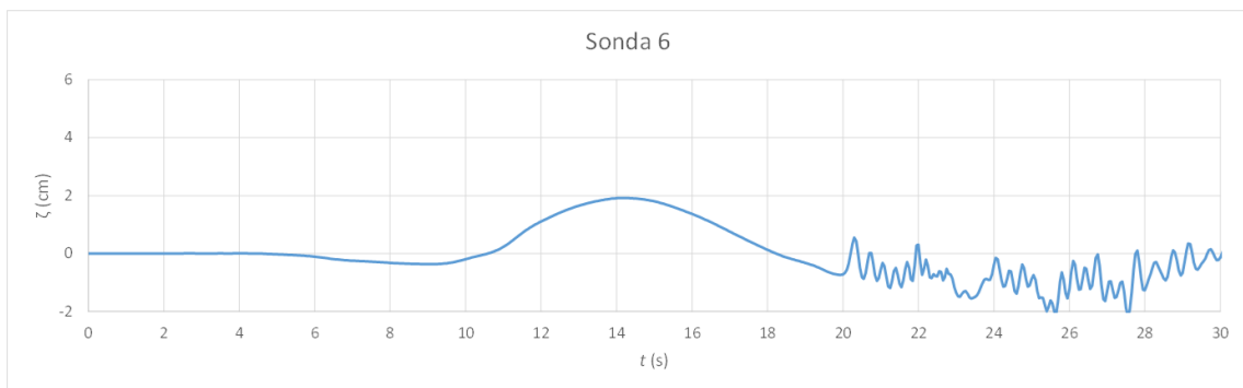
Figura 4.11 – Elevação da superfície livre na Sonda 6: (—) simulação com o SWASH.
