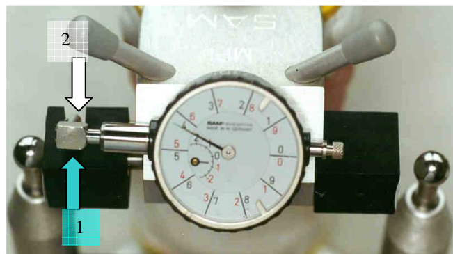
Figura 9 - IPM® a avaliar o \Delta Y . 1 – braço de medição do “relógio”, 2 – ranhura do cubo esquerdo.
