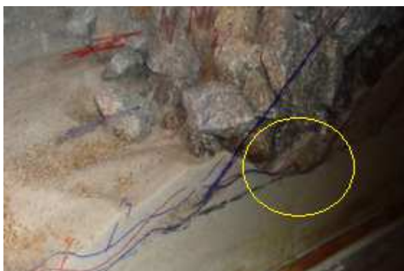
Figura 38 – Erosões no pé de talude e acumulação de areia imediatamente a seguir à estrutura
