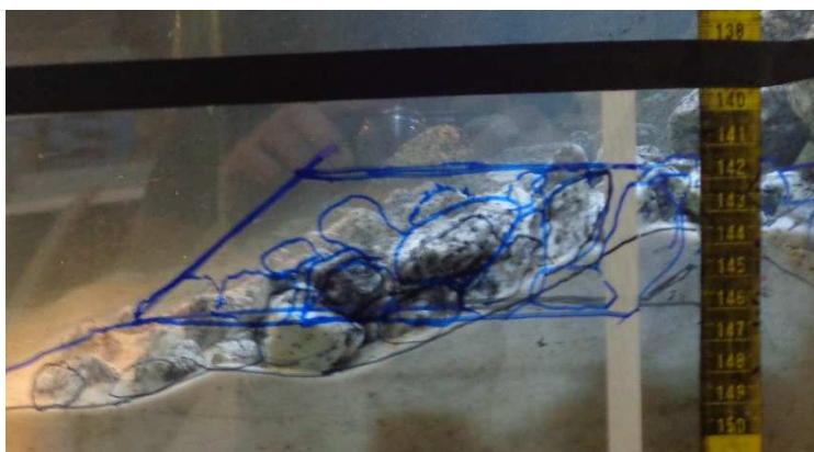
Figura 71 – Deposição de sedimento na zona de transição manto/risberma no ensaio 1.2.5
