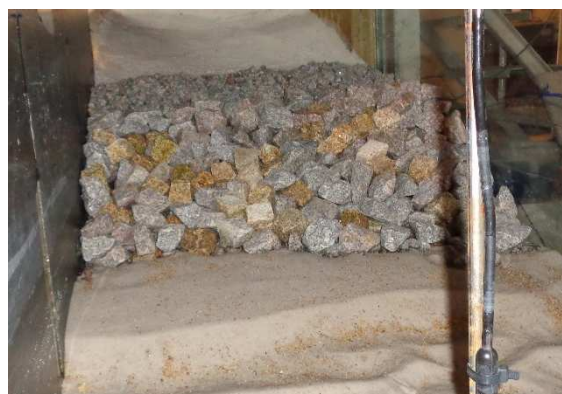
Figura 38 – Erosões no pé de talude e acumulação de areia imediatamente a seguir à estrutura
