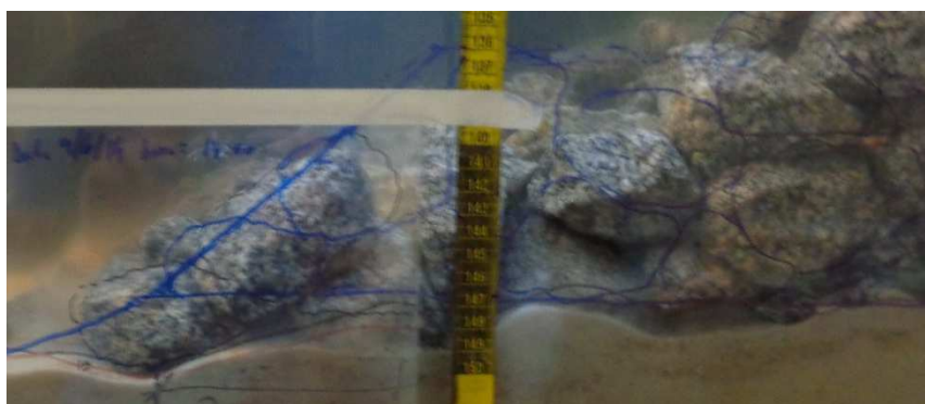
Figura 72 – Exemplo da erosão verificada na zona de transição manto/risberma no ensaio 2.2.3
