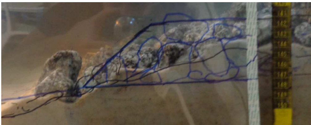
Figura 49 – Perfil do fundo e deslocamento da risberma no ensaio 1.2.3
