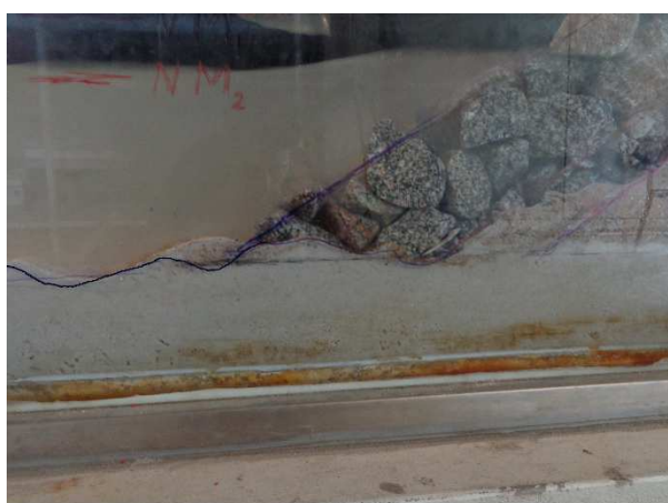
Figura 35 – Perfil do fundo próximo ao pé de talude durante o ensaio 0.3
