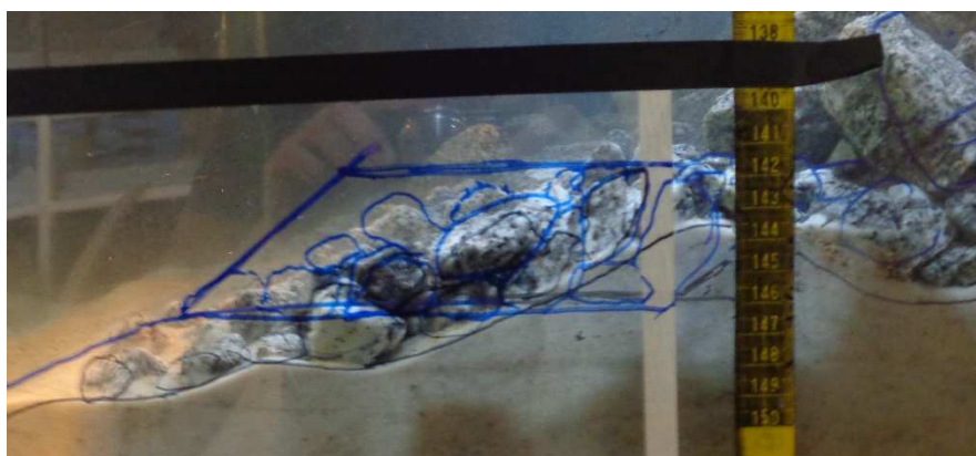
Figura 52 – Perfil do fundo e deslocamento da risberma no ensaio 1.2.5
