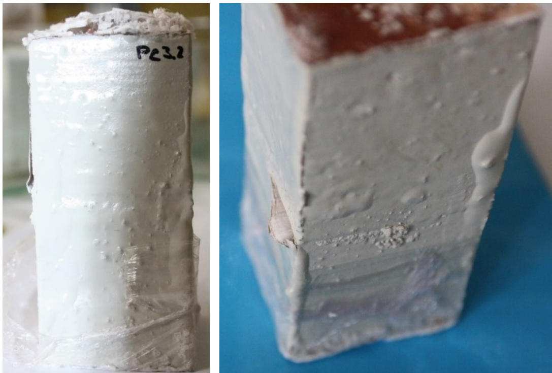
Fig. 3.37 - Descolagem (Esquerda) e rotura da resina epóxi pelos cristais de Na 2 SO 4
