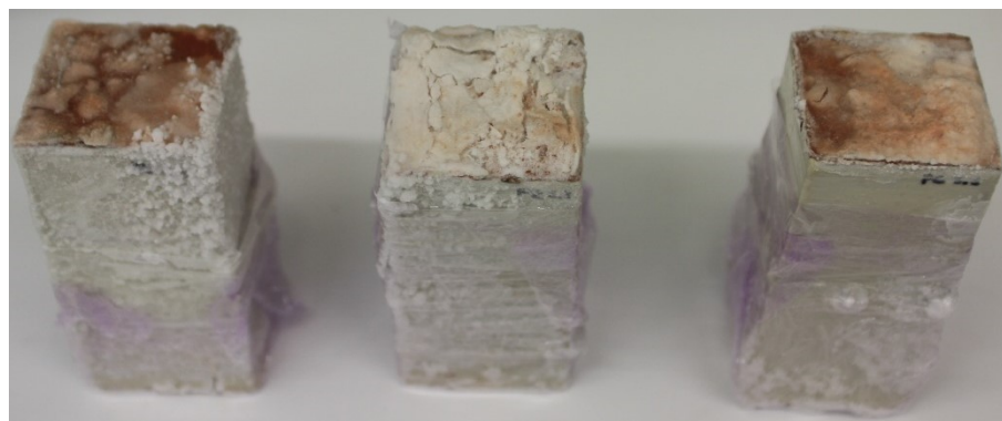
Fig. 5.20 - Provetes pasta de contacto, parcialmente imersos em solução saturada de cloreto de potássio, antes do início do segundo ciclo de reabsorção
