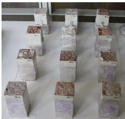
Fig. 4.2 - Provetes, previamente em contacto com solução saturada de \text{KCl} , no início do ensaio de secagem
