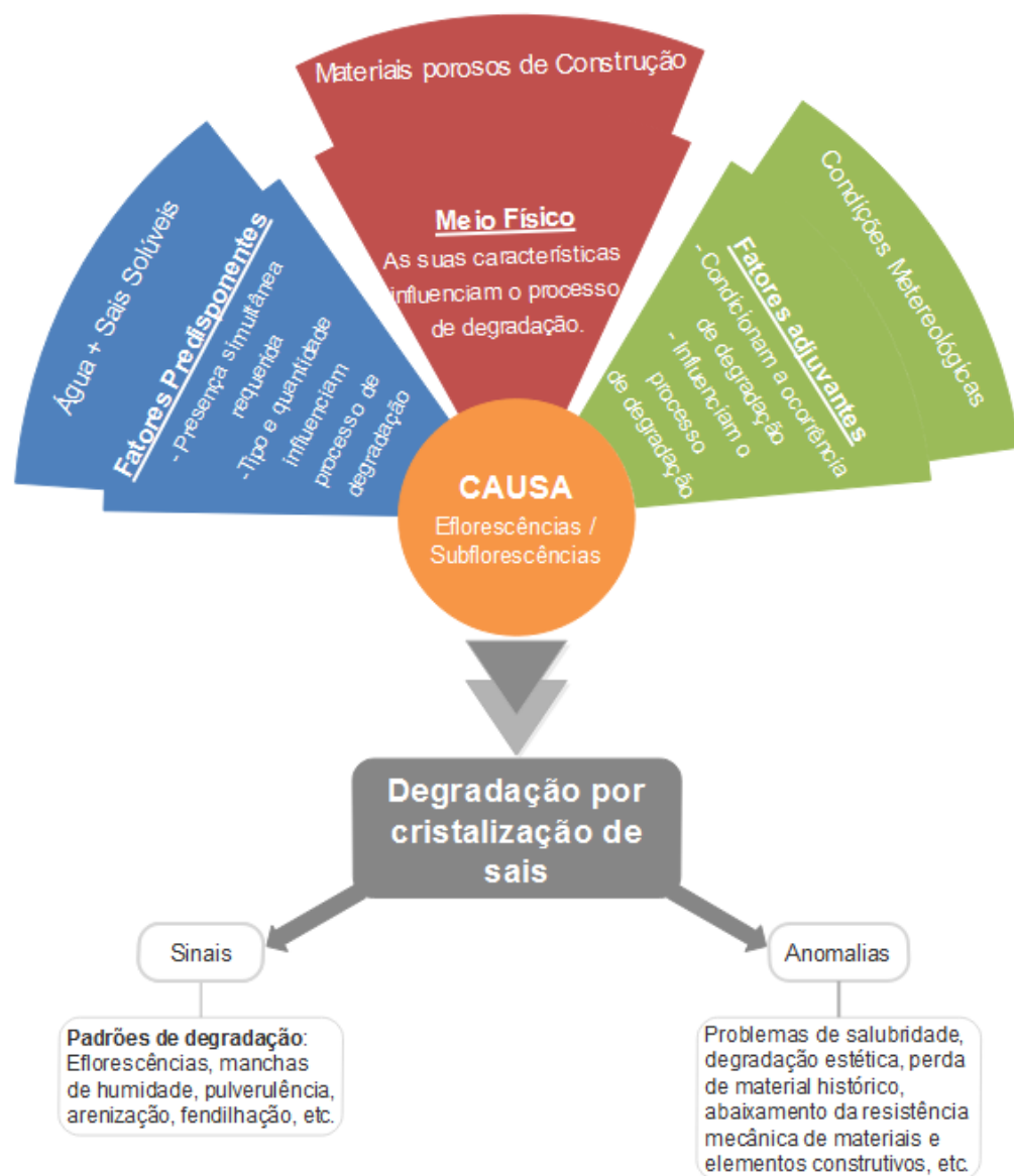
Fig. 2.18 - Degradação por ação dos sais, adaptado [1]
