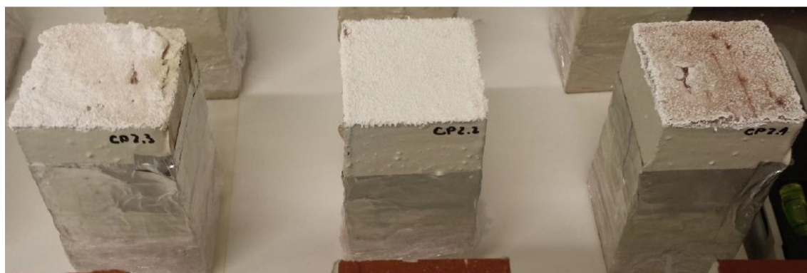
Fig. 3.21 - Provetes de contacto perfeito, imersos em solução saturada de sulfato de sódio, no final do ciclo de absorção (2014) [3]
