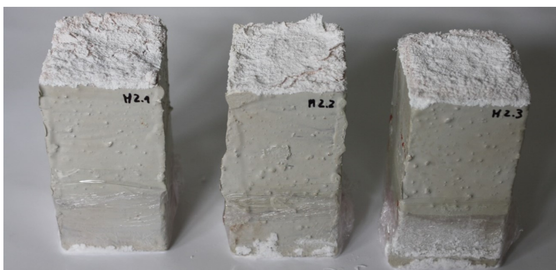
Fig. 3.10 - Provetes monolíticos imersos em solução saturada de sulfato de sódio, antes do início do ensaio de absorção
