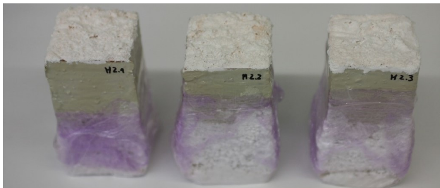
Fig. 4.6 - Provetes monolíticos parcialmente imersos em água, na 1ª semana de secagem (cima) e na 36ª semana de secagem (baixo)
