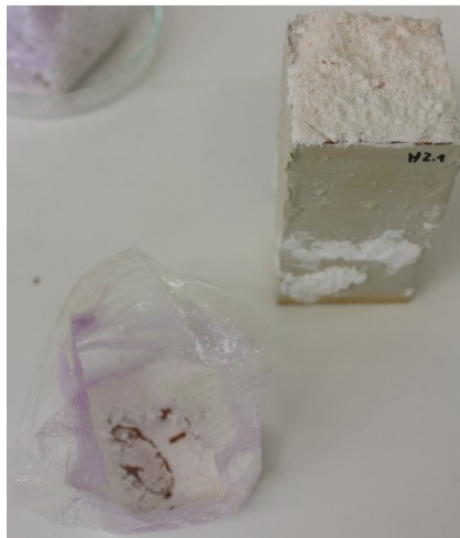
Fig. 5.4 - Placas de tijolo libertadas para a folha de polietileno, no final do ensaio de secagem
