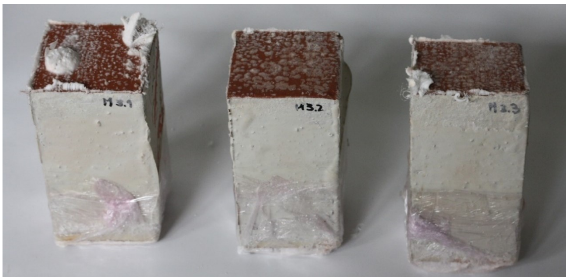
Fig. 3.13 - Provetes monolíticos imersos em solução saturada de cloreto de potássio, antes do início do ensaio de absorção
