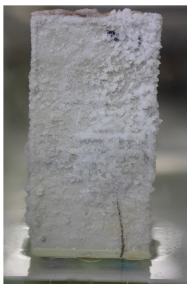
Fig. 5.21 - Fratura da base do provete PC3.2
