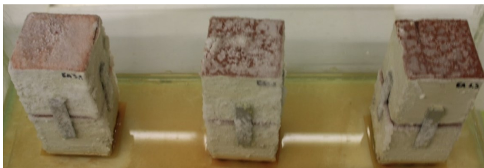
Fig. 5.30 - Provetes espaço de ar, parcialmente imersos em solução saturada de cloreto de potássio, na 4ª semana do segundo ciclo de reabsorção
