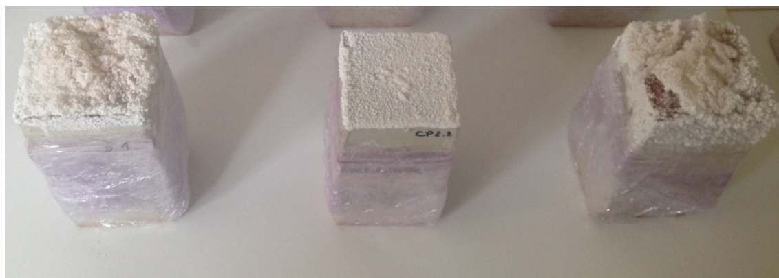
Fig. 3.22 - Provetes de contacto perfeito, imersos em solução saturada de sulfato de sódio, no final do primeiro ciclo de reabsorção (2015)
