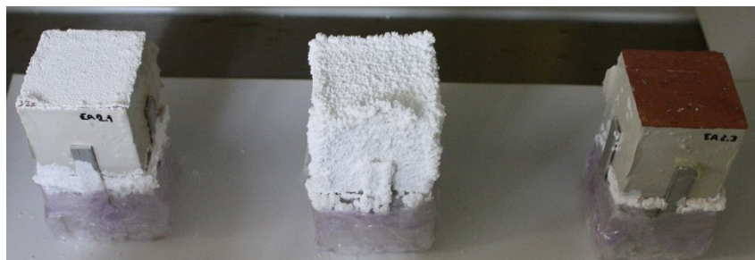
Fig. 4.1 - Provetes de espaço de ar, previamente em contacto com solução saturada de \text{Na}_2\text{SO}_4 , com a base selada com folha de polietileno, no início do ensaio de secagem
