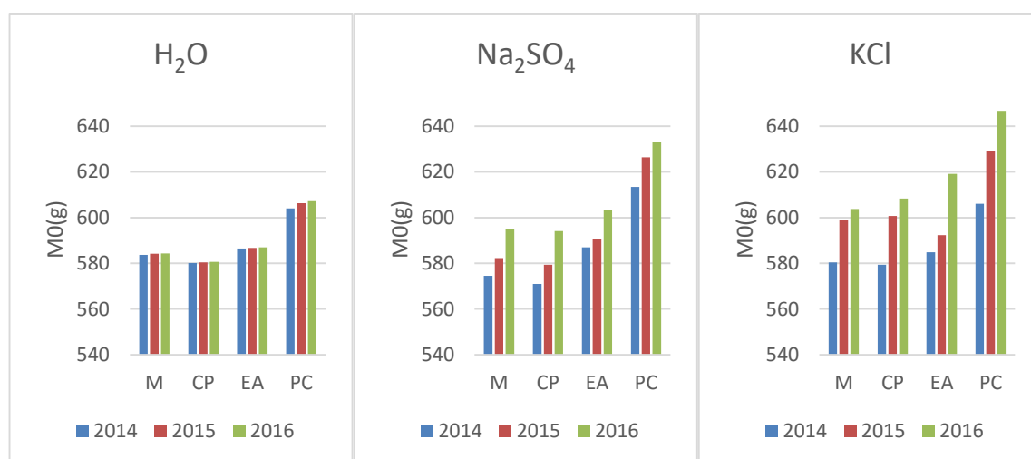
Fig. 5.1 - Diferença de massa seca (M 0 ) dos provetes imersos em água, solução saturada de sulfato de sódio e solução saturada de cloreto de potássio (2014, 2015 e 2016)
