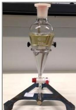
Figura 18 - Separação de fases (Fase menos densa - biodiesel; Fase mais densa - glicerol) para o protocolo C
