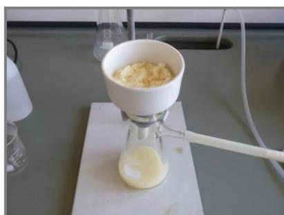
Figura 6 – Filtração por sucção
