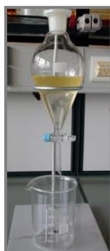
Figura 3 - Separação de fases (Biodiesel e Glicerina)
