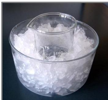
Figura 3 - Mistura de NaOH com água/etanol arrefecida
