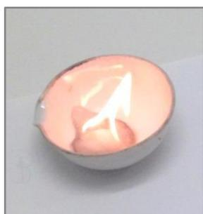
Figura 19 - Teste de combustão do biodiesel
