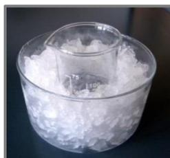
Figura 2 - Mistura de NaOH com água/etanol arrefecida
