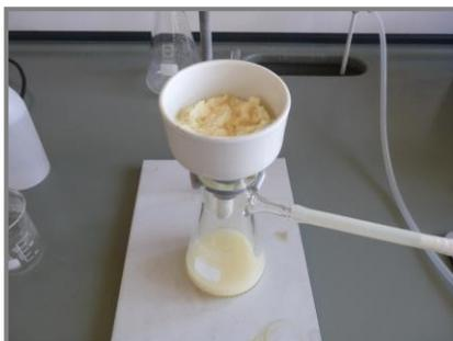
Figura 5 - Filtração por sucção
