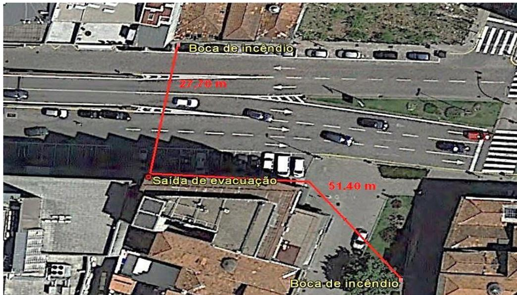
Fig. 4.14 – Localização e distância das bocas-de-incêndio mais próximas da saída de evacuação.
