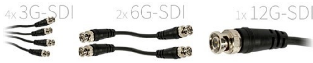
Figura 2.18: Ilustração de diferentes tipos de transporte de um vídeo com payload até 12 Gb/s. Da esquerda para a direita: quad-link 3G-SDI , dual-link 6G-SDI e single-link 12G-SDI . [5]
