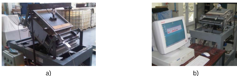
Figura 6.2 - Equipamento de ensaio de corte em plano inclinado: a) vista geral; b) computador usado para aquisição dos dados.
