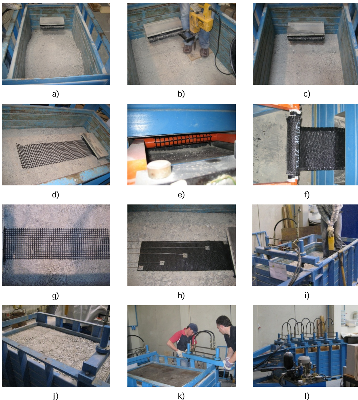
Figura 4.17 - Algumas fases de montagem do ensaio de arranque: a), b) e c) colocação e compactação da 1ª camada de solo; d) colocação do geossintético; e) e f) colocação dos geossintéticos às garras; g) fixação dos potenciômetros ao geossintético) e j) colocação e compactação das camadas de solo superior em duas camadas; k) colocação da placa de neoprene e calçadores de pressão no topo do solo compactado.
