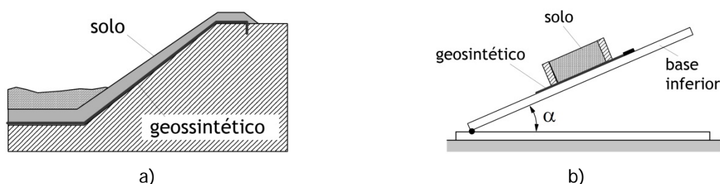
Figura 2.35 - Ensaio de corte em plano inclinado, adaptado de Palmeira (2009): a) talude lateral de aterro de resíduos; b) esquema de ensaios de corte em plano inclinado.
