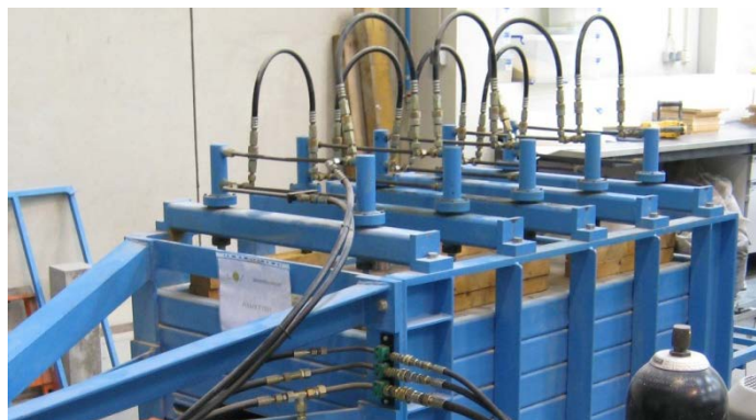
Figura 4.15 - Cilindros calcadores que aplicam a tensão de confinamento.
