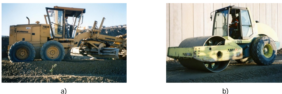
Figura 4.4 - Equipamento usado para: a) espalhamento e nivelamento; b) compactação.
