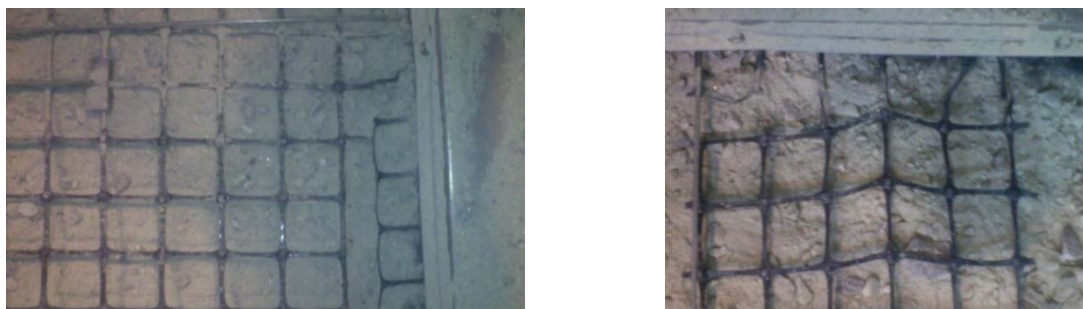
Figura 5.30 - Geossintético GGE2 após o ensaio de arranque.
