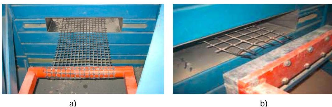
Figura 4.16 - Pegas do equipamento de arranque; a) pega cilíndrica; b) pega em cunha.
