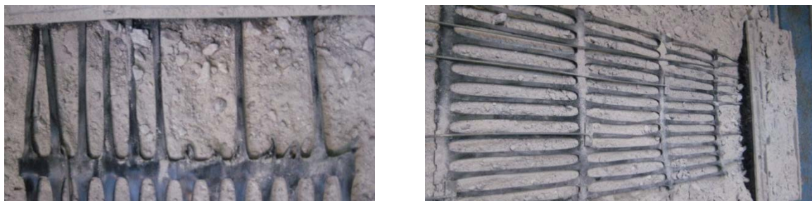
Figura 5.48 - Fotografias de provetes do GGEu intacto após ensaio de arranque.
