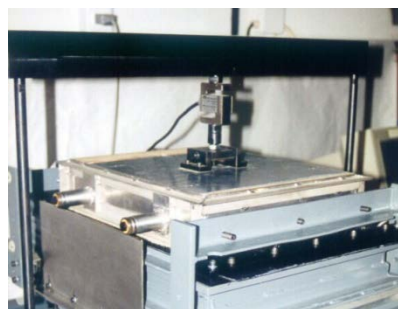
Figura 4.21 - Equipamento de ensaio de corte em plano inclinado: a) barras de fixação do geossintético; b) sistema de aplicação da força normal.
