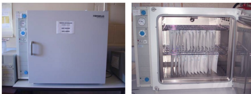
Figura 3.2 - Equipamento para expor os geotêxteis ao ensaio de termo-oxidação, Carneiro (2009).
