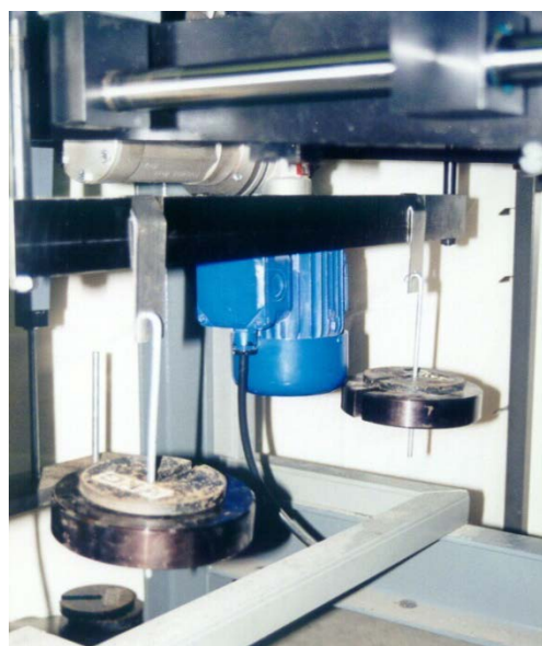
Figura 4.22 - Sistema de aplicação da força normal: a) pesos suspensos na extremidade de uma alavanca; b) aplicação dos pesos diretamente na barra inferior do pendural.
