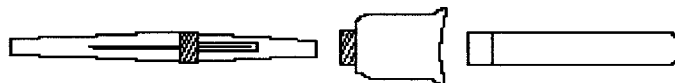
Fig. 4: "vacutainer" (com tampas de protecção), porta-tubos e tubo, dispostos segundo a forma como se adaptam.
