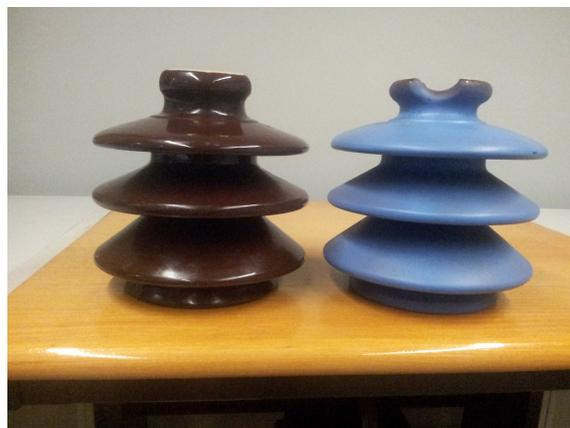
Figura 2.7: Isoladores de porcelana para suporte de linhas elétricas, sendo que o exemplar da direita foi revestido com borracha de silicone em toda a sua superfície.
