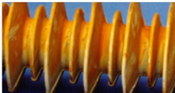
Figura 4.2: Exemplo de mudança de cor do revestimento de um isolador compósito [22].
