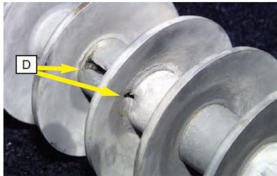
Figura 4.14: Exemplo de pequena perfuração no revestimento do isolador na parte inferior, o qual pode rapidamente expandir-se para uma situação semelhante à do topo [21].
