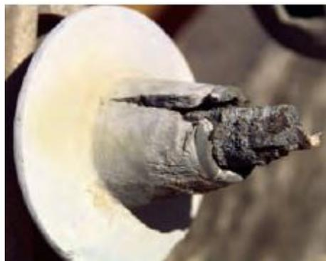
Figura 4.20: Carbonização da vara FRP e consequente falha mecânica [21].
