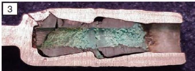
Figura 4.21: Separação do núcleo dos terminais metálicos devido à decomposição da matriz de resina e excesso de carga mecânica [21].
