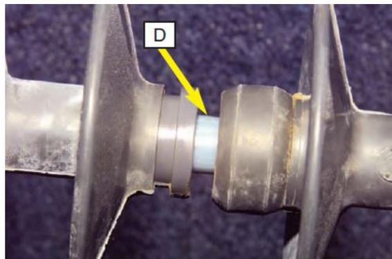
Figura 4.15: Desunião entre aba e revestimento do núcleo [21].
