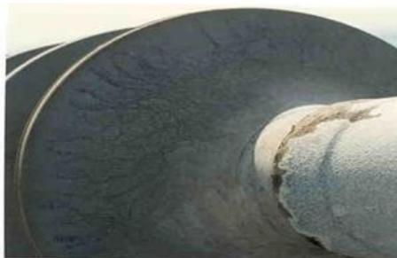
Figura 4.3: Exemplo de fissuras nas abas do revestimento [22].
