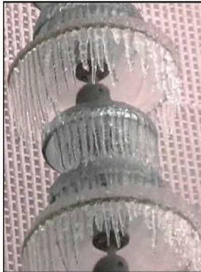
Figura 5.2: Formação de camada vertical de gelo num isolador cerâmico com perfil alternado [35].
