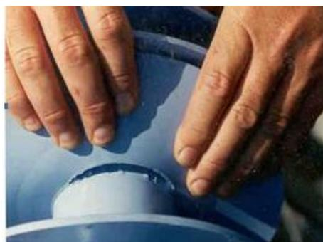
Figura 4.7: Caso de desunião entre aba e revestimento [22].
