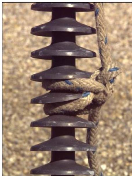
Figura 5.11: Forma incorreta de içar um isolador composto. A corda deve ser atada nos terminais metálicos por forma a não danificar as abas [42].
