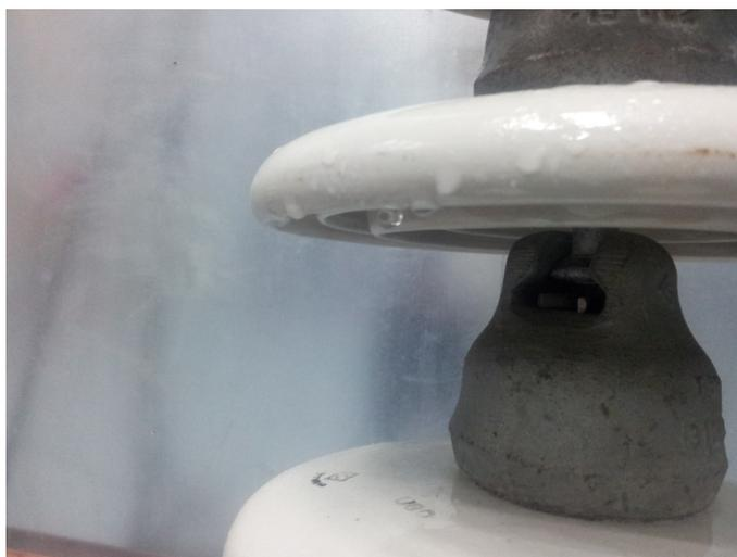
Figura 8.5: Coalescência da água pulverizada nas extremidades do isolador de porcelana.
