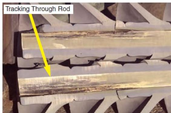
Figura 4.19: Vara FRP seccionada axialmente com registo de rastejamento devido a disrupções internas [21].
