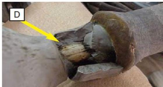
Figura 4.17: Degradação severa do revestimento e exposição do núcleo, resultante de ações de atividades elétricas na superfície [21].
