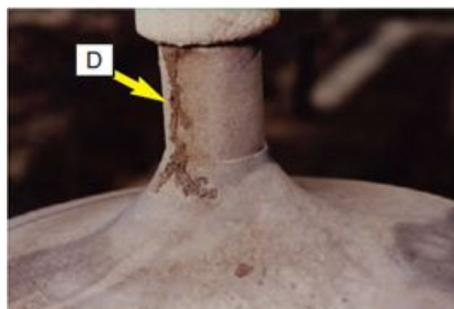
Figura 4.12: Caso de ocorrência de rastejamento severo perto do terminal metálico [21].
