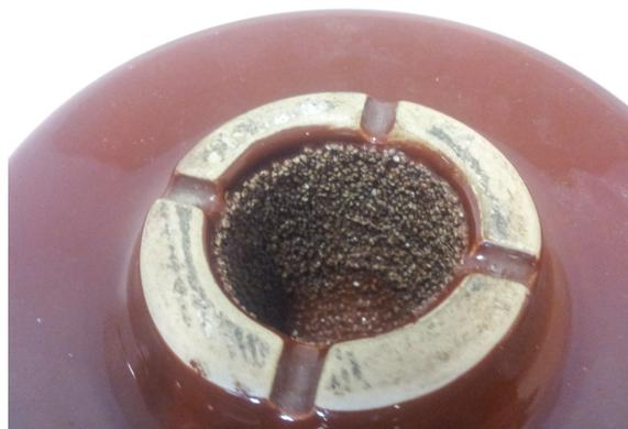
Figura 2.6: Exemplo de colagem de areia a garantir maior aderência entre o cimento e o material dielétrico.
