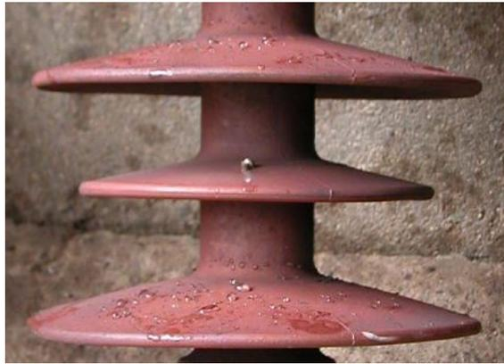
Figura 5.1: Caso de transferência de propriedade hidrofóbica para camada de poluição [30].
