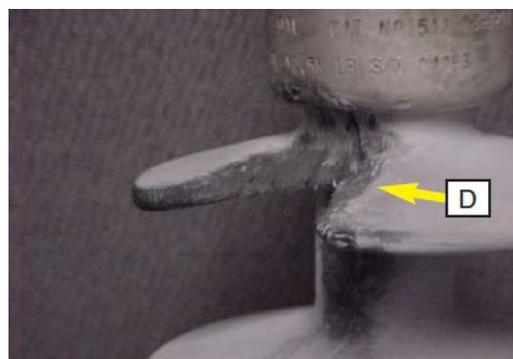
Figura 4.16: Caso de erosão severa na aba e revestimento do núcleo [21].
