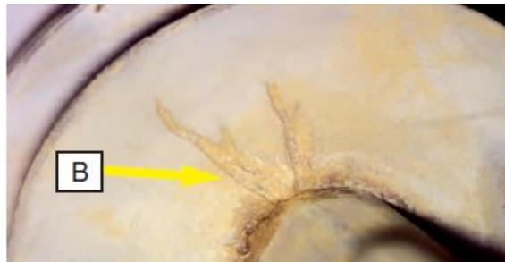
Figura 4.6: Erosão ligeira numa aba perto do terminal metálico [21].
