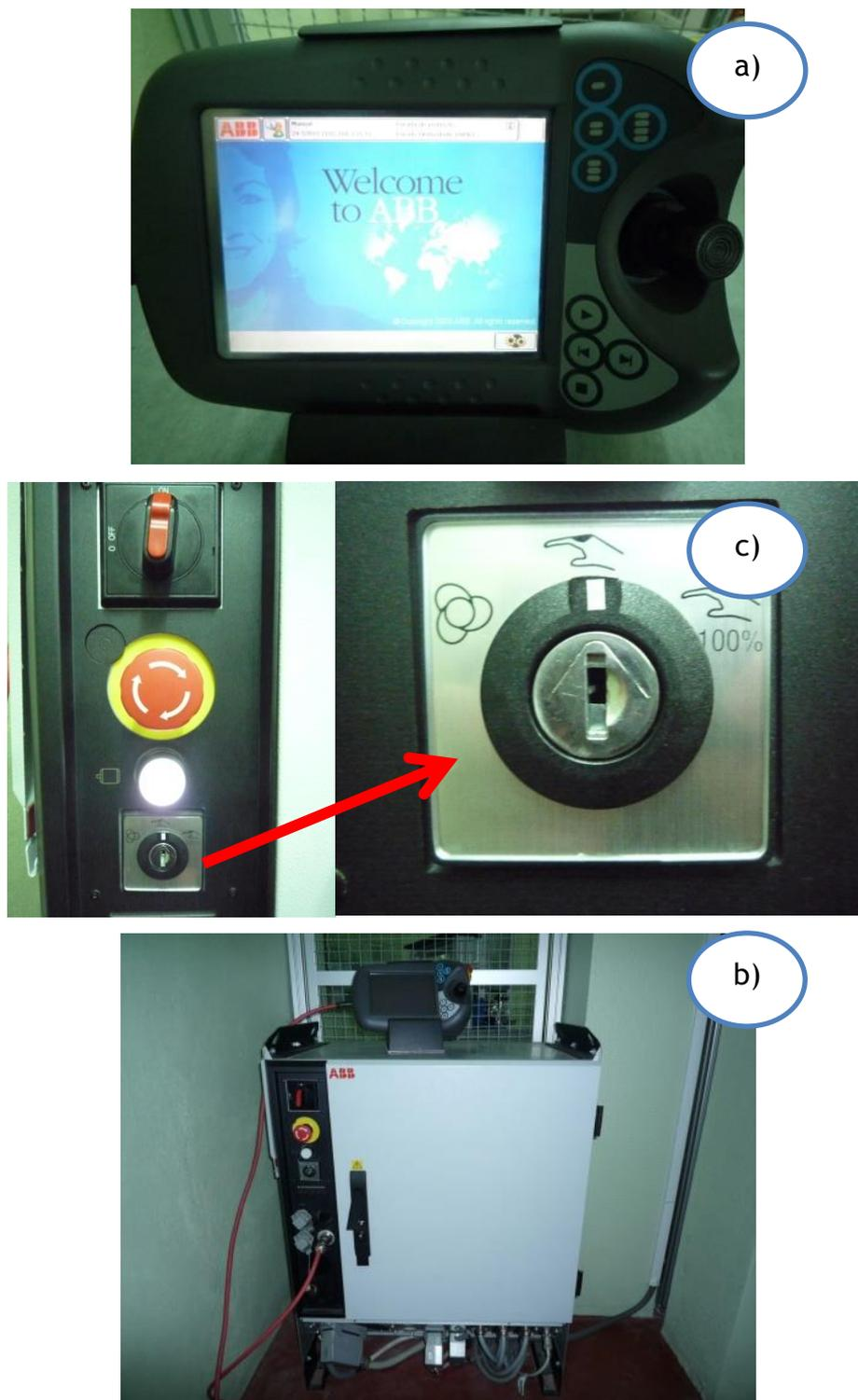
Figura A-1 - Elementos constituintes do controlador da célula robótica: a) *Flexpendant*; b) Painel de controlo; c) Botões de acionamento da célula, ligação dos motores, seleção do modo de funcionamento e interrupção de emergência.
