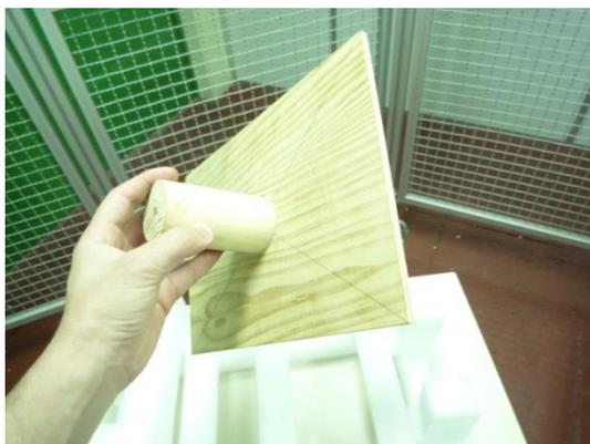
Figura 4-2 - Bloco de madeira de suporte construído na oficina de carpintaria do CINFU.
