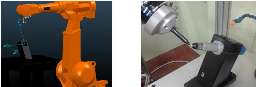
Figura 4-13 -Nova configuração da célula. a) Célula virtual. Eixo de ferramenta (Azul) localizado no centro do suporte do *spindle*. b) Calibração do *spindle* com o auxílio da ferramenta ponteira.
