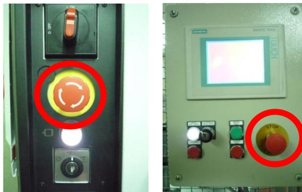
Figura 1-6 - Botões de paragem de emergência da célula robótica do CINFU.
