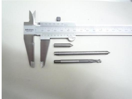
Figura 4-22 - Duas ponteiros de calibração fabricadas no torno CNC e uma fresa esférica de 6mm de diâmetro.
