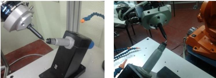
Figura 4-23 - Calibração da ferramenta e medição dos comprimentos das ponteiros.
