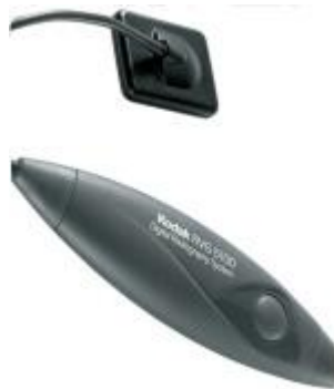
Figura 1.11: Exemplo de um sistema digital de aquisição directa com utilização da tecnologia CMOS. (Adaptado de: http://www.carestreamdental.com/en/digital-imaging/intraoral-radiography/kodak-rvg-5100.aspx )
