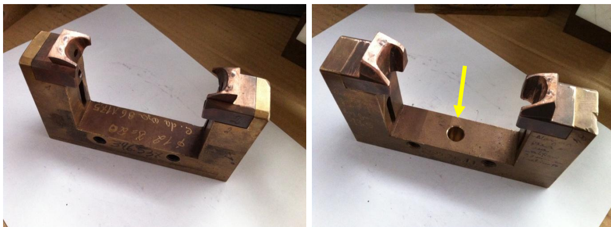
Figura 39: Exemplo de alteração das ferramentas inferiores - antes e depois
