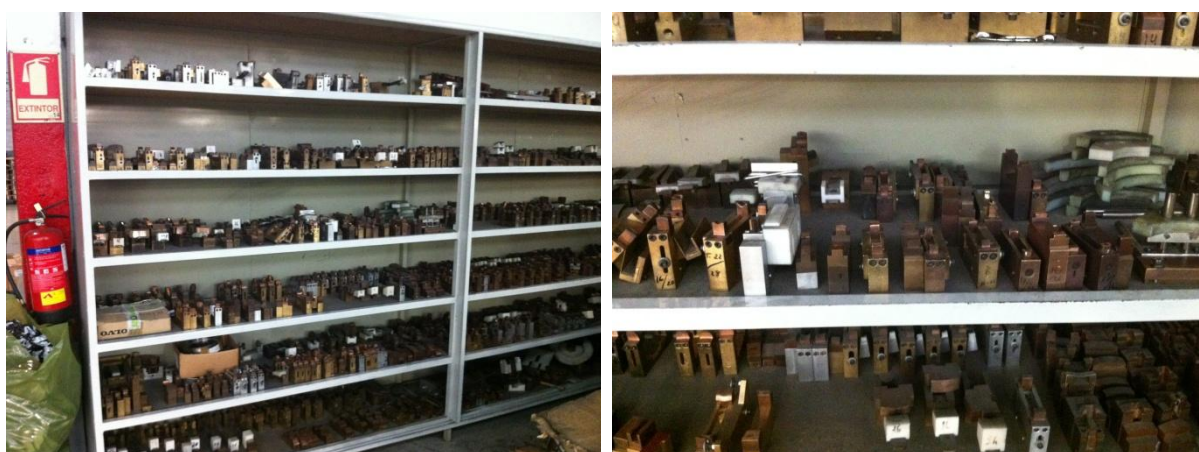
Figura 30: Armário das ferramentas sem qualquer identificação visível - antes dos 5S
