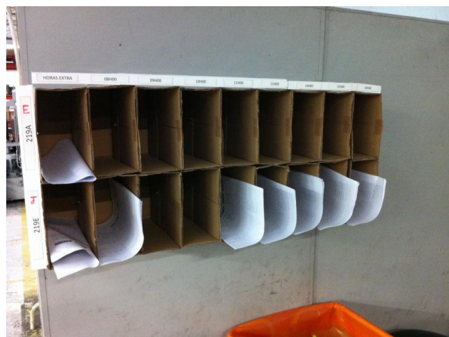
Figura 29: Caixa de nivelamento
