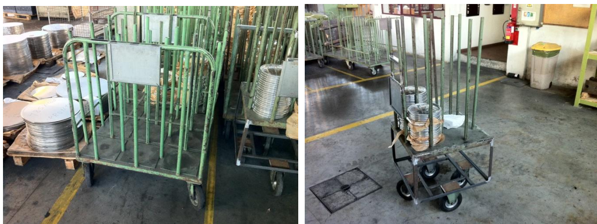
Figura 45: Carro de tampas painelas de pressão – antes e depois
