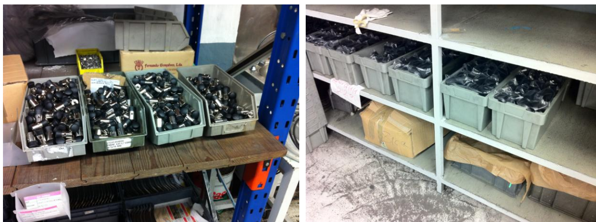
Figura 20: WIP - Válvulas rotativas, do lado esquerdo; sacos de acessórios, do lado direito - resultado de pré-montagem e introdução posterior na linha
