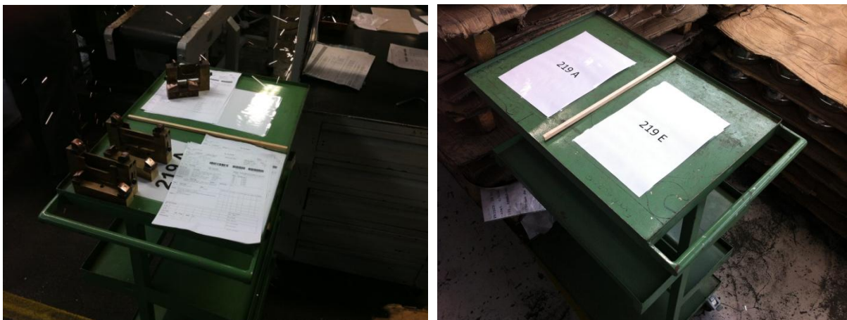
Figura 28: Carros SMED para transporte de ferramentas
