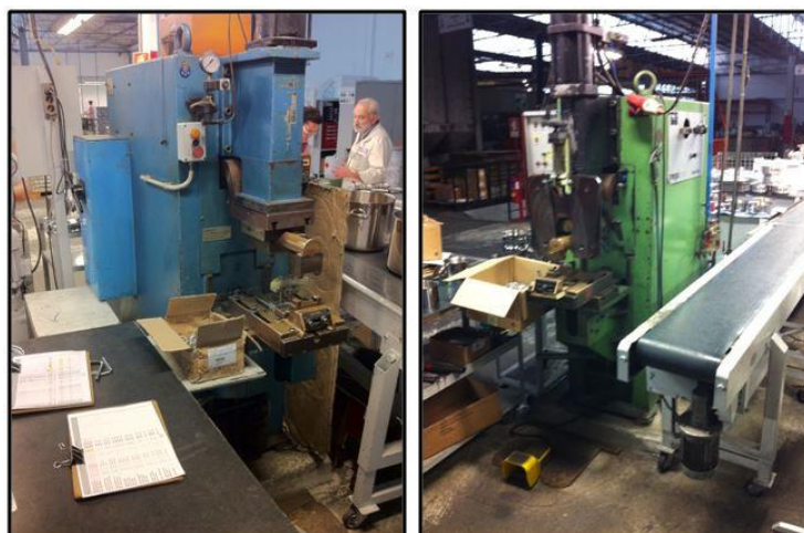
Figura 19: Máquinas de soldadura por resistência. 219A do lado esquerdo, 219E do lado direito
