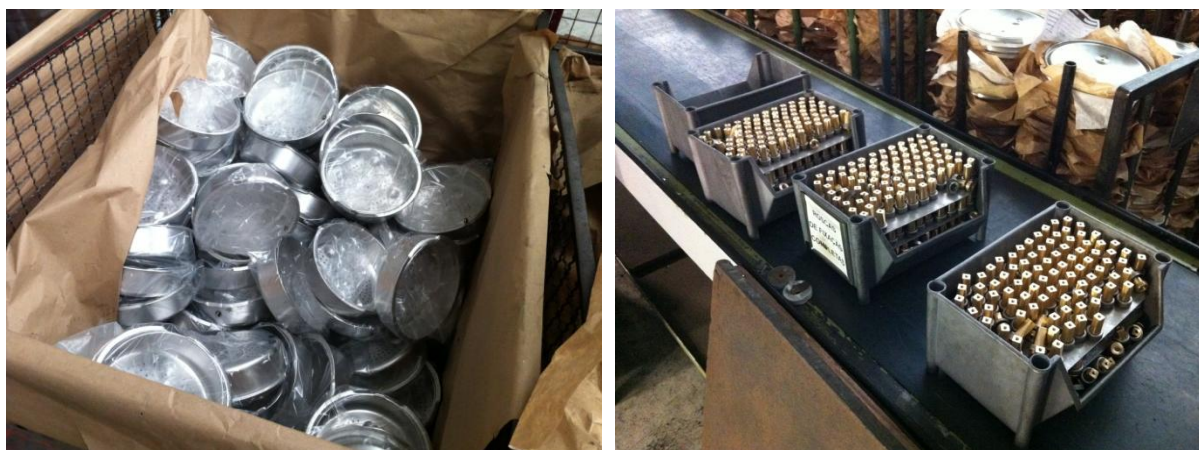
Figura 21: WIP - Cestos previamente montados e ensacados, do lado esquerdo; e roscas de fixação montadas, do lado direito
