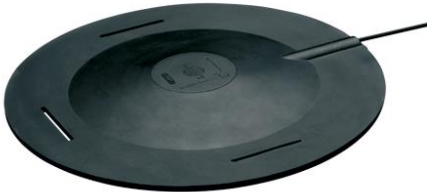
Fig. 4.2 – Transdutor de assento que contém três acelerómetros independentes que medem simultaneamente o nível de vibração nos três eixos ortogonais – X, Y e Z (Brüel & Kjær) [13].
