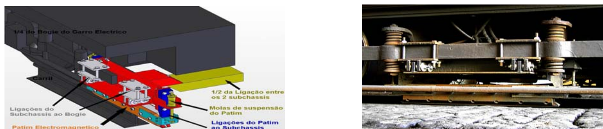
Fig. 10: Sistema de travagem de emergência para carros eléctricos históricos do Porto.
