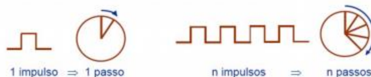
Figura 6- Esquema representativo da conversão de impulso em movimento
