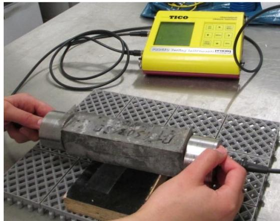
Figura 121 Transmissão direta num prisma (direção de medição a 0°)
