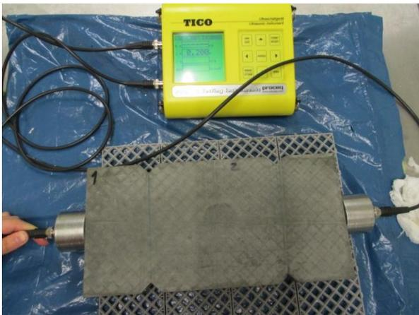
Figura 122 Transmissão direta numa placa (direção de medição a 0°)
