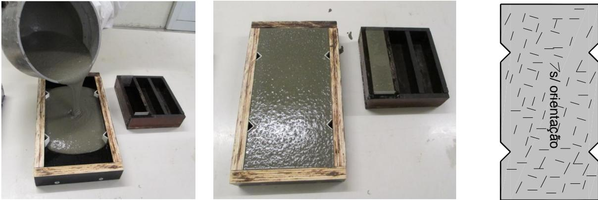
Figura 99 Betonagem de uma placa e prisma para a obtenção de fibras sem orientação
