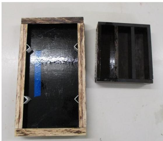
Figura 93 Cofragem de uma placa  $304 \times 150 \times 25 \text{ mm}^3$  e de 3 prismas  $160 \times 40 \times 40 \text{ mm}^3$
