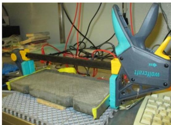
Figura 136 Medição da resistividade método dos dois elétrodos exteriores numa placa na direção 0°
