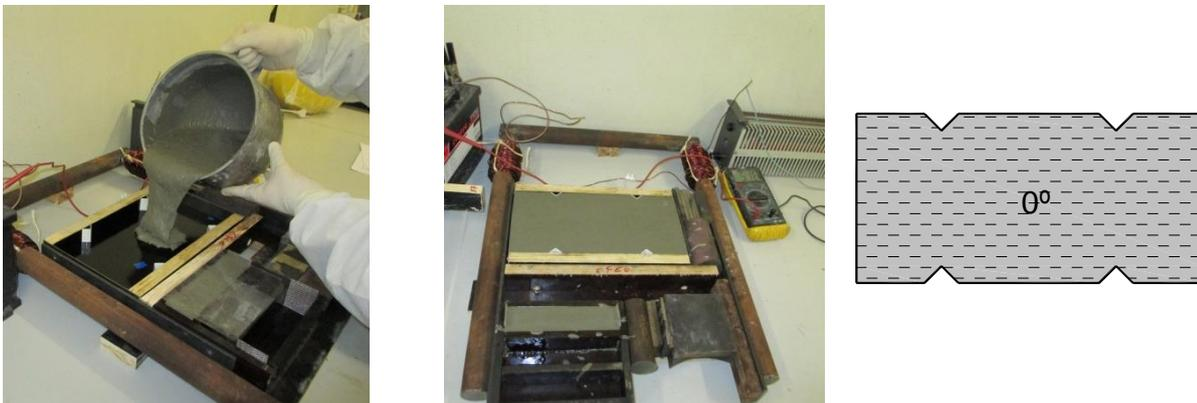
Figura 100 Betonagem de uma placa e prisma para a obtenção de fibras com orientação a 0°
