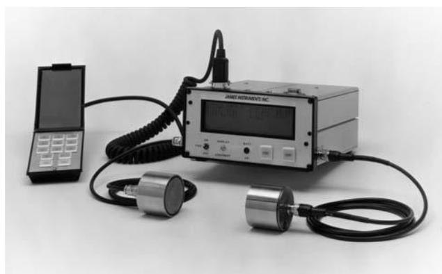
Figura 48 Equipamento utilizado para a medição dos ensaios UPV. [60]
