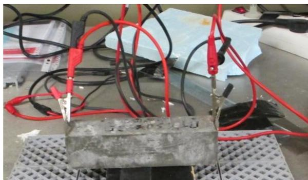
Figura 133 Medição da resistividade método dos dois elérodos embebidos num prisma (ensaio realizado na direção 0°)
