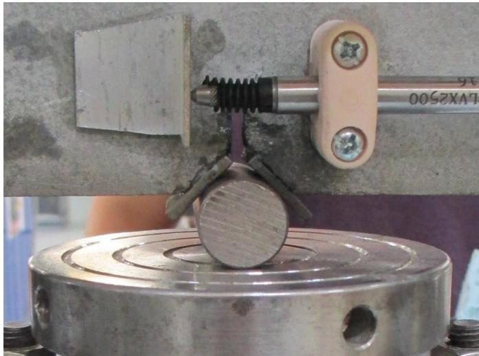
Figura 128 Pormenor do contacto entre o varão de aço e as chapas de aço
