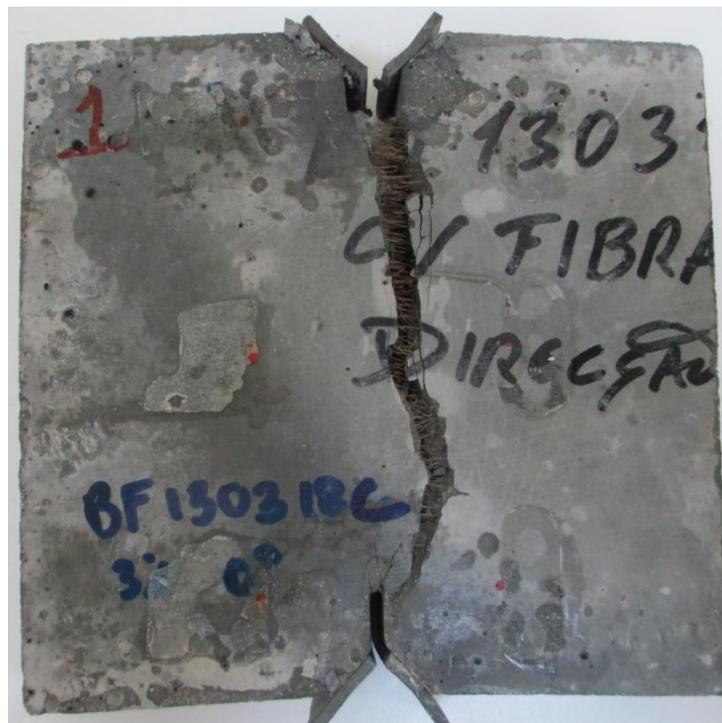
Figura 156 Placa com 3% de fibras orientadas a 0° depois de submetida ao ensaio DEWST
