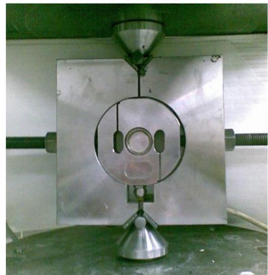
Figura 31 Equipamento utilizado para a determinação do coeficiente de atrito [55]
