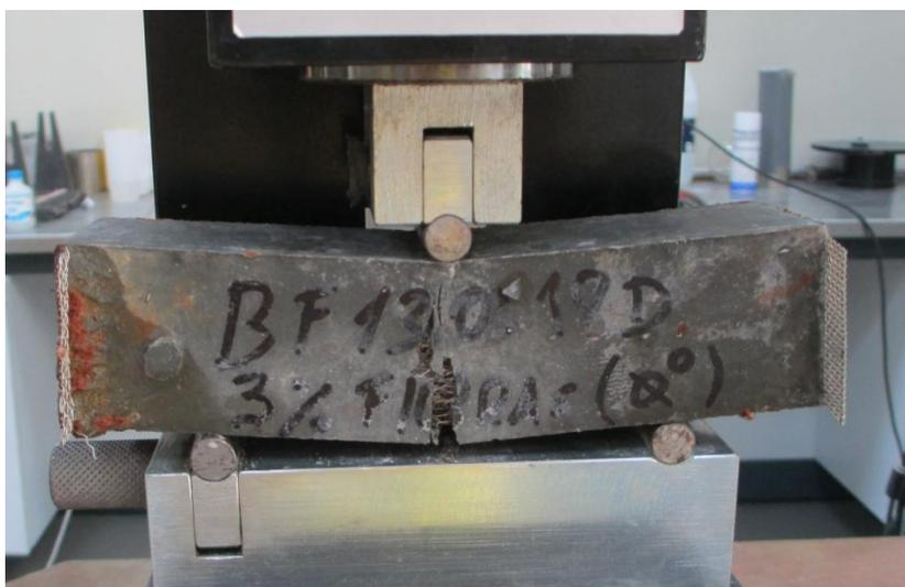
Figura 153 Ensaio à tração por flexão de um prisma com fibras orientadas a 0°
