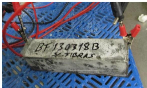
Figura 102 Prisma com redes embebidas em duas faces opostas. Resistividade medida na direção  $0^\circ$
