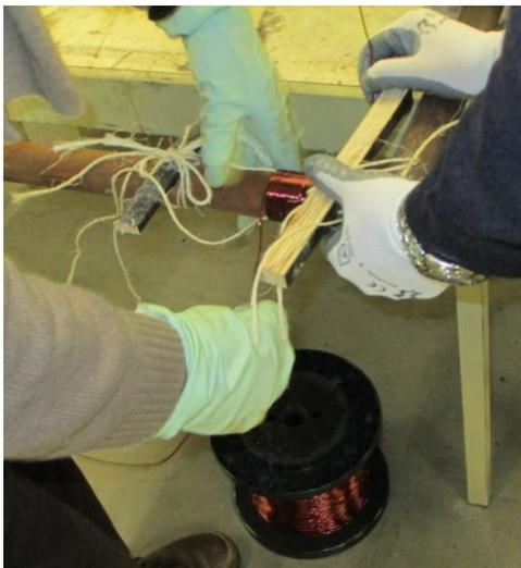
Figura 86 Construção de uma das bobines do equipamento
