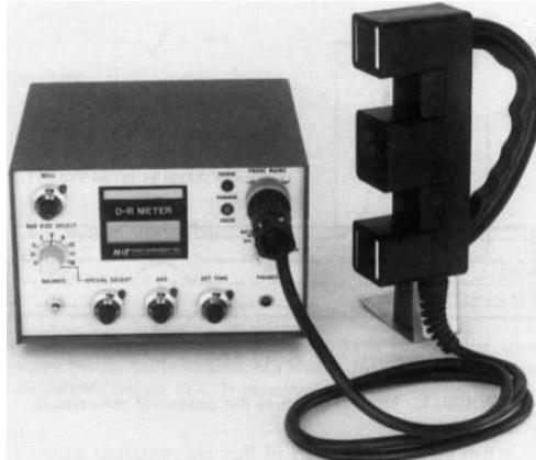
Figura 49 Equipamento utilizado para o ensaio de indutância [60]
