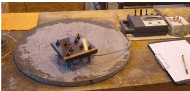
Figura 47 Medição da resistividade com equipamento de quatro sondas [58]
