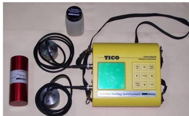
Figura 115 Equipamento de ensaios de UPV utilizado
