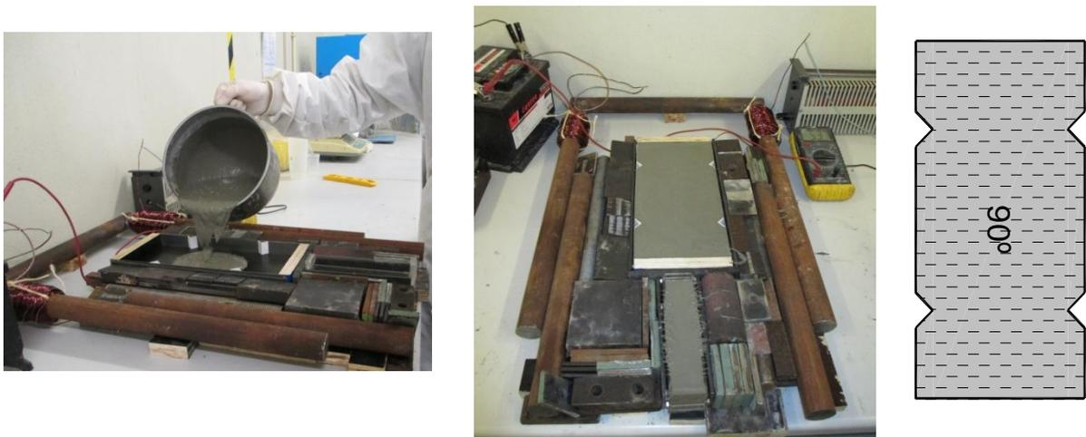
Figura 101 Betonagem de uma placa e prisma para obtenção de fibras com orientação a 90°
