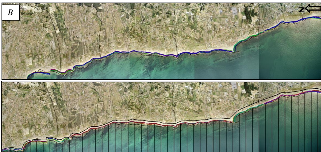
Figura 11: A) Excerto do mapa representativo das linhas de costa em séries temporais, desde 2003 até 2012, a partir do contato seco/molhado; B) Linhas de costa e seus respectivos transeptos.
