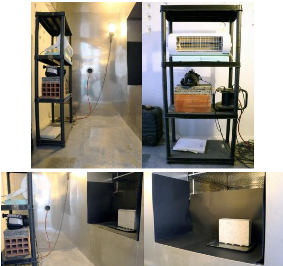
Fig. 3.6 - Disposição dos equipamentos e dos provetes no interior da câmara climática
