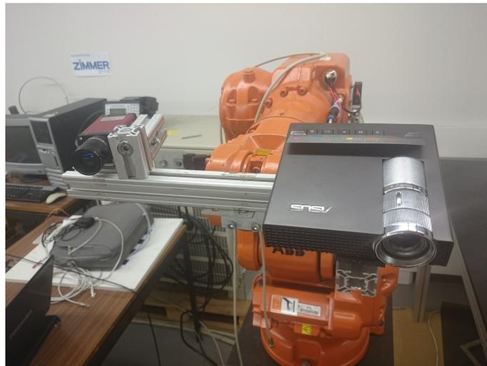
Figura 4.3: Suporte sistema câmara-projetor
