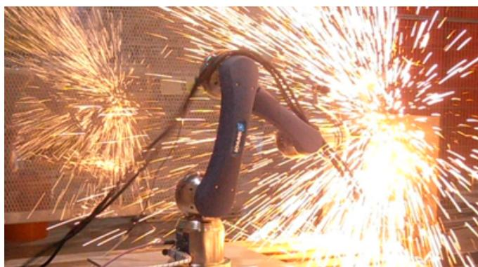
Figura 3.2: Testes de soldadura com o manipulador [6]
