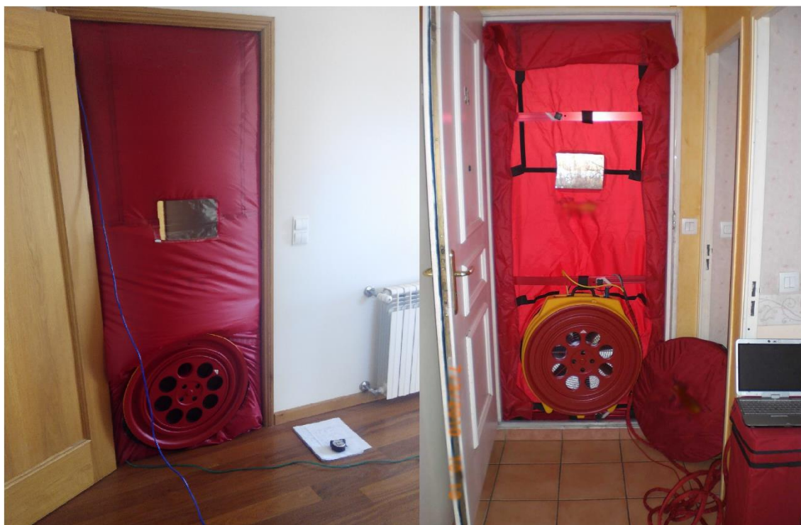
Figura 3.5- Imagem com o equipamento montado da porta ventiladora.
