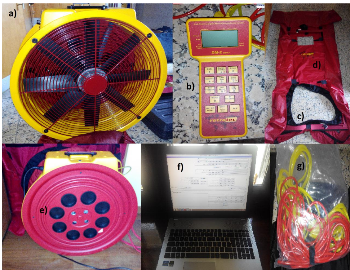
Figura 3.4- Imagem com todos os componentes do ensaio de porta ventiladora.
