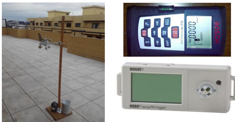
Figura 4.1- Esquerda: Estação meteorológica; Direita superior o medidor de laser e inferior HOBO UX100.
