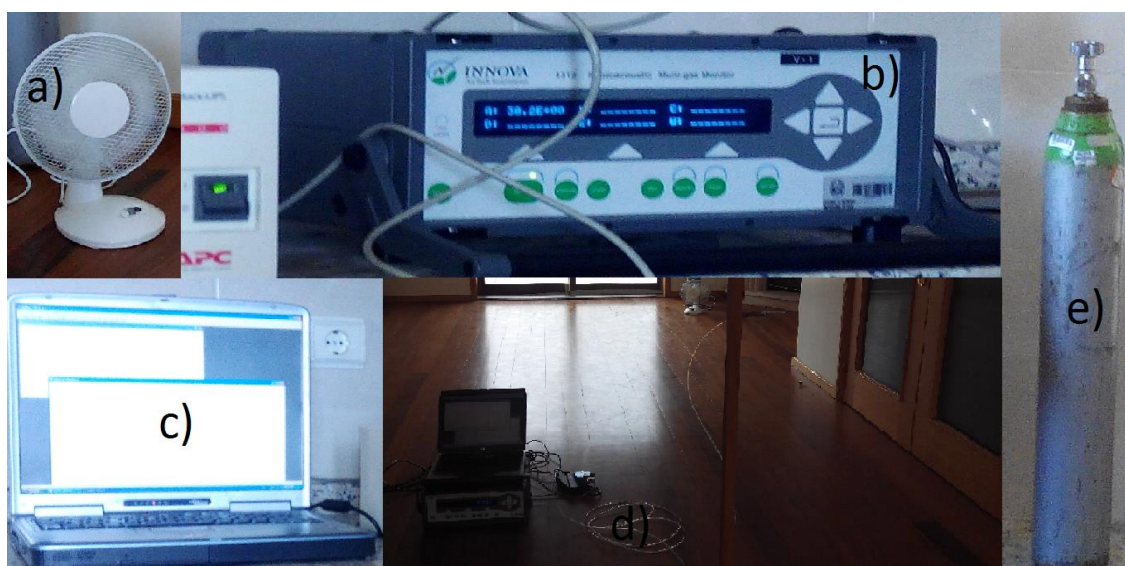
Figura 3.8- Imagem com todos os componentes do ensaio de gás traçador.
