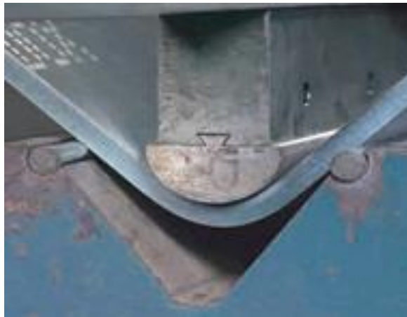
Figura 1.7 – Quinagem no ar sem flexão livre. [B. Pacheco 2013]
