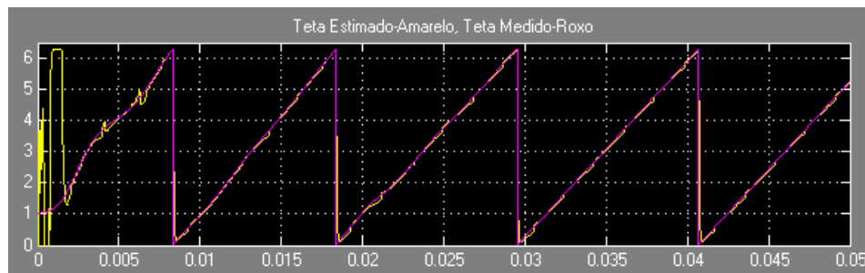
Figura 3.59: Resultados da estimação da posição do rotor com o método 3 da estimação da velocidade com deslocamento inicial de 60° elétricos para \omega_r > 0 .
