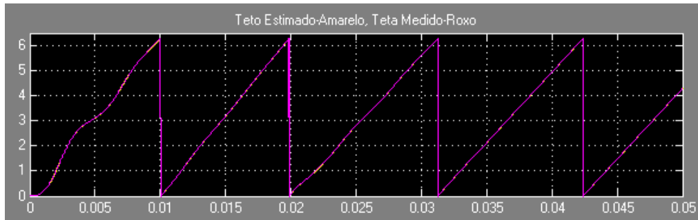
Figura 3.50: Estimação da posição do rotor com o método 5 da estimação da velocidade sem deslocamento inicial para \omega_r > 0 .
