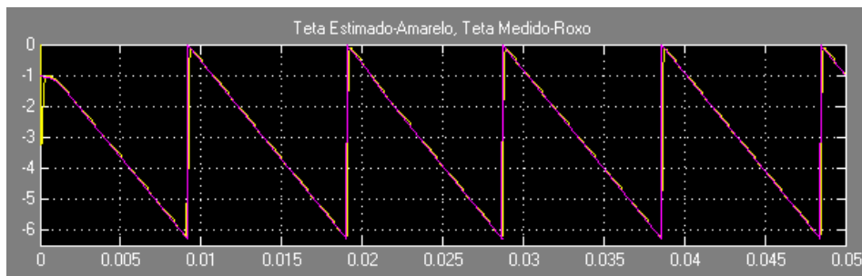
Figura 3.65: Resultados da estimação da posição do rotor com o método 5 da estimação da velocidade com deslocamento inicial de 60^\circ elétricos para \omega_r < 0 .
