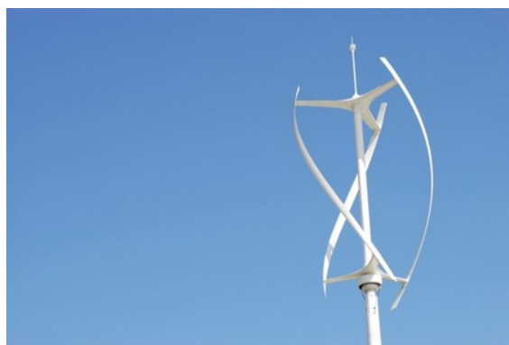
Figura 2.8: Turbina com eixo vertical; Fonte: [5]
