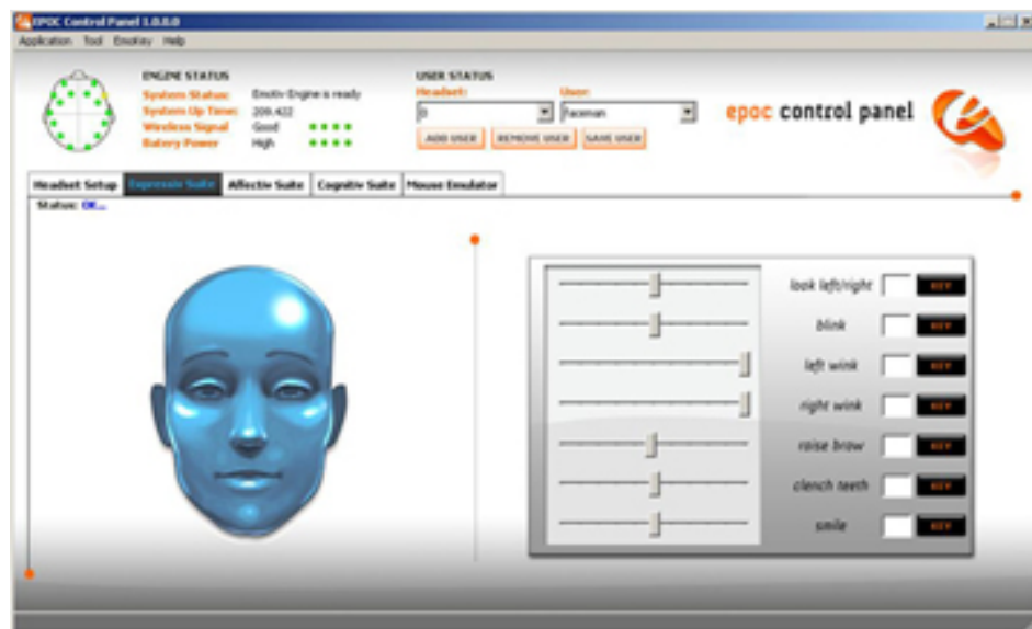
Fig.2 Janela do SDK do EPOC para monitorização da Expressiv Suite
