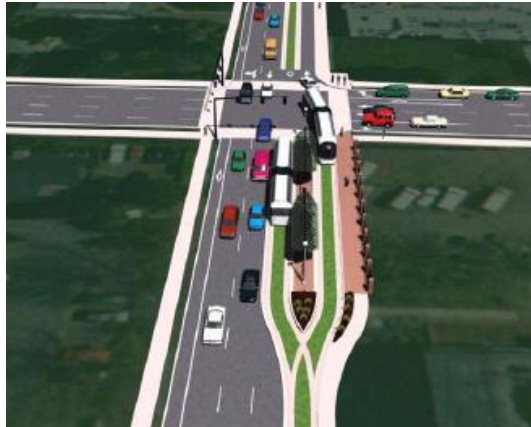
Fig.34 – Operação em via única, Eugene. (Lane Transit District)
