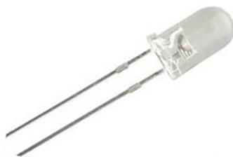
Figura 55 – Exemplo de um LED[68]
