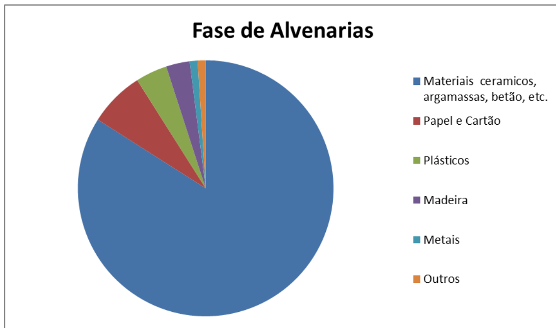
Gráfico 3-Composição percentual dos resíduos produzidos na fase de alvenarias (Reixach et al. 2000a).
