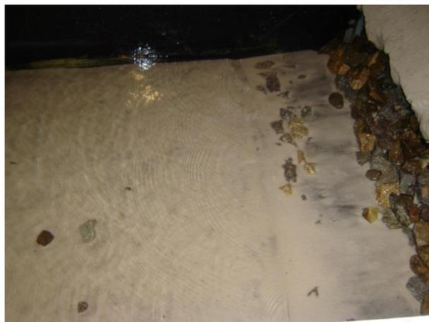
Figura B.5.9 – Deslocamentos máximos de blocos de enrocamento por instabilidade
