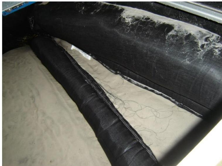
Figura 29 – Instabilidade do 1º tubo geossintético. Ensaio A.5.
