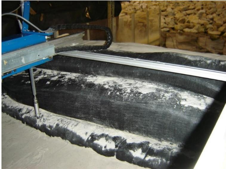
Figura 19 – Modelo A: Estrutura em geossintéticos
