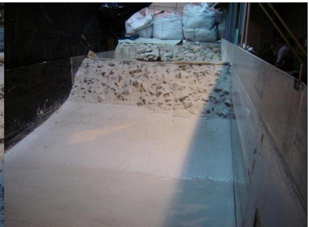
Figura B.1.2 – Modelo com a estrutura em enrocamento antes do ensaio em 2º plano
