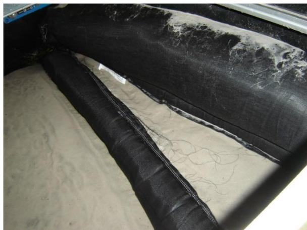
Figura A.5.3 – Rotura do primeiro tubo geossintético no final do 2º ciclo
