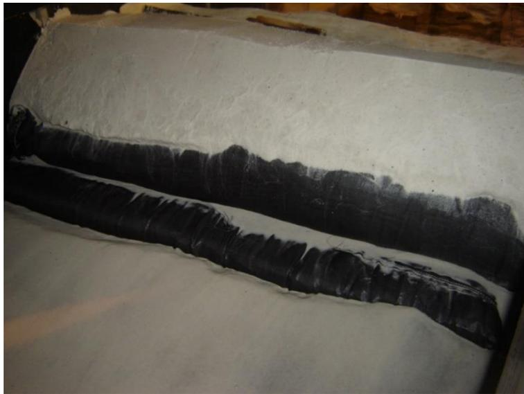
Figura 32 – Erosão na parte frontal da estrutura. Ensaio A.7.
