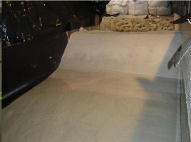
Figura B.4.2 – Estrutura adicionada do 1º volume de areia antes do ensaio
