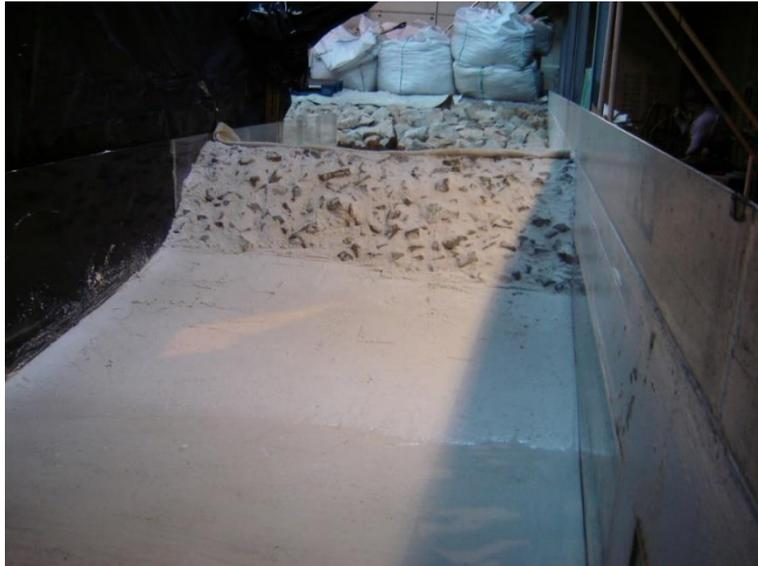
Figura 22 – Modelo B: Estrutura em Enrocamento
