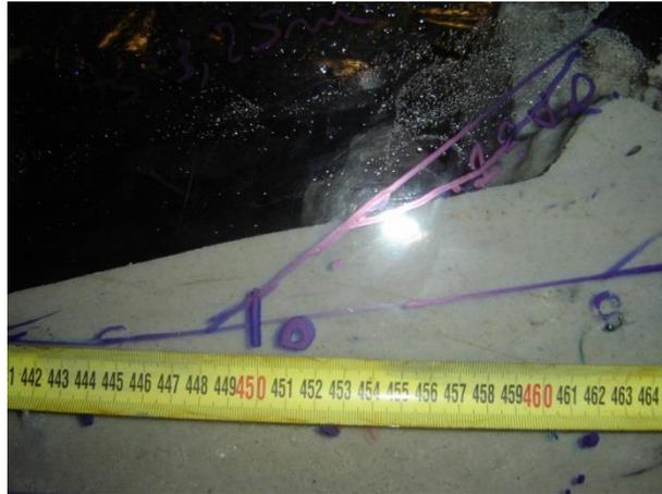
Figura A.8.1 – Erosão do 1º volume e acreção na base do talude
