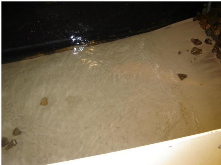
Figura 46 – Exemplo de deslocamentos máximos de blocos em relação à estrutura. Ensaio B.4
