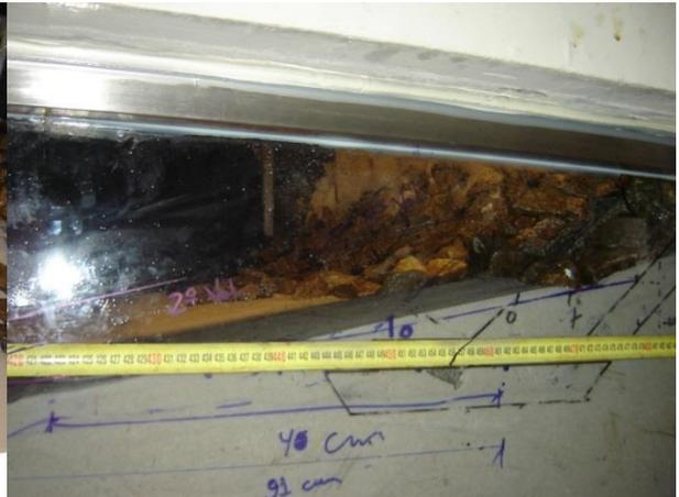
Figura B.9.12 – 2º volume quase totalmente erodido
