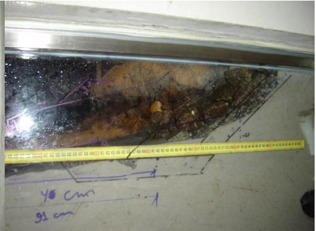
Figura B.5.6 – Erosão do 1º volume e na zona da risberma
