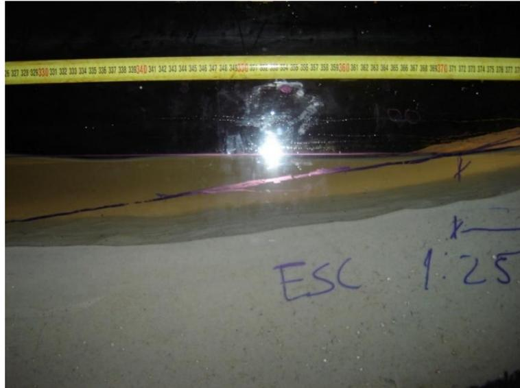
Figura 28 – A medição do perfil era realizada pelas distâncias a partir do limite superior da régua.
