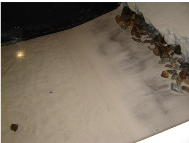
Figura B.5.3 – Deslocamento do bloco de enrocamento no final do 1º ciclo
