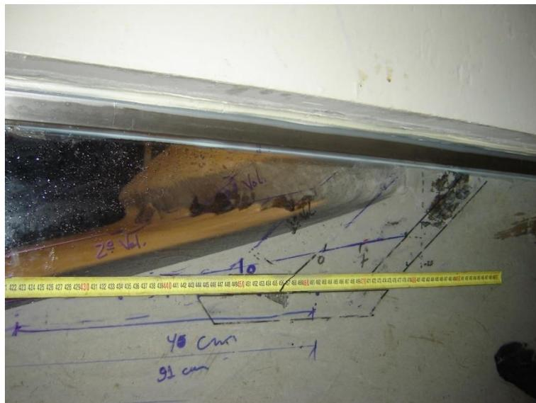
Figura 49 – Aproximadamente 50 % do 2º volume é erodido. Ensaio B.7.
