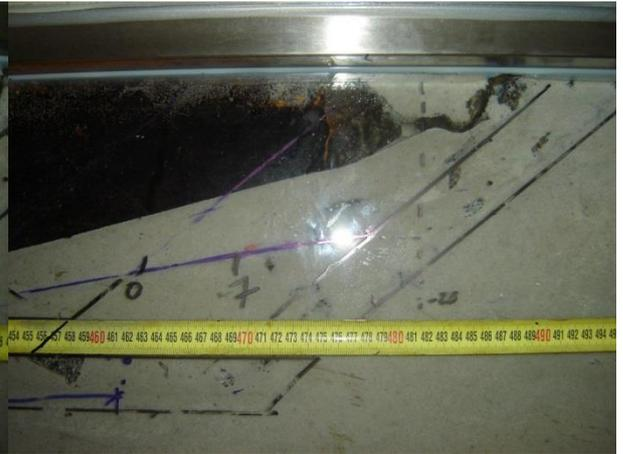
Figura B.2.3 – Erosão na base do talude no final do 1º ciclo
