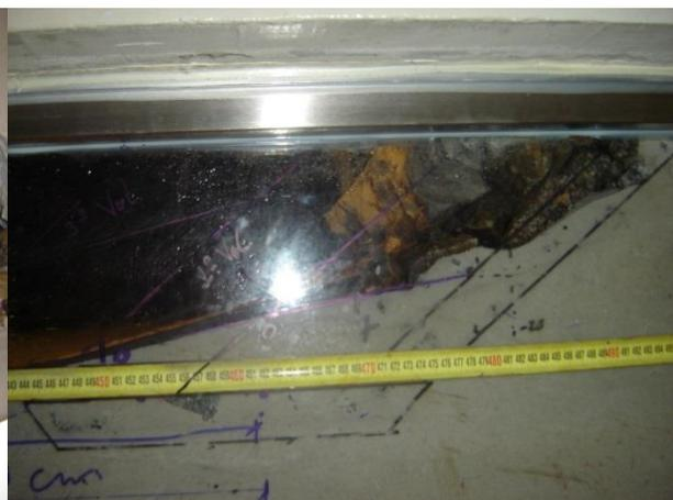
Figura B.5.4 – Erosão do 1º volume no final do 1º ciclo na base do talude
