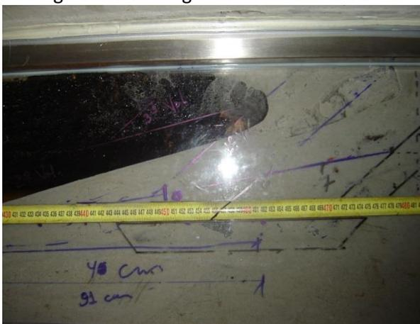
Figura B.8.7 – Pormenor da erosão no 2º e o 3º volume no final do 2º ciclo
