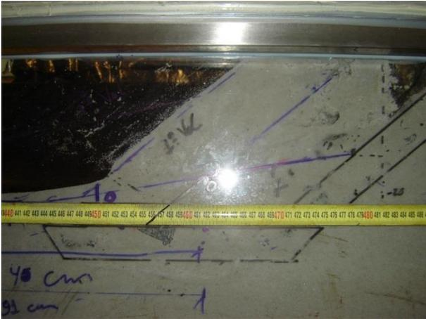
Figura B.4.1 – Perfil transversal na zona da base do talude com destaque para a disposição do 1º volume de areia e da primeira camada de enrocamento
