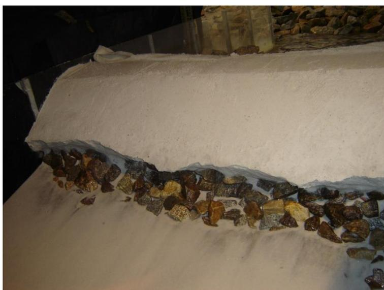
Figura 44 – Estrutura no final do 2º ciclo. Ensaio B.3.
