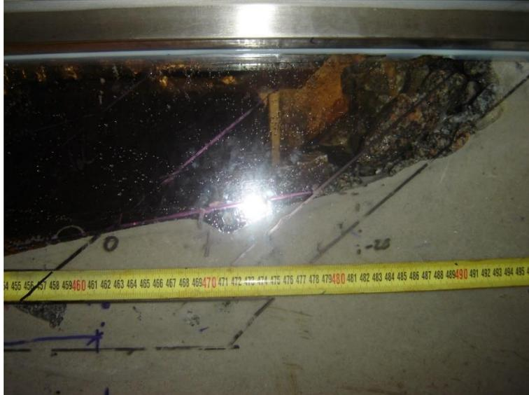
Figura 47 – Perfil transversal da estrutura na zona da base do talude após 1º ciclo. Ensaio B.4
