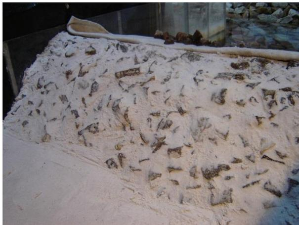
Figura B.1.1 – Modelo com a estrutura em enrocamento em 1º plano
