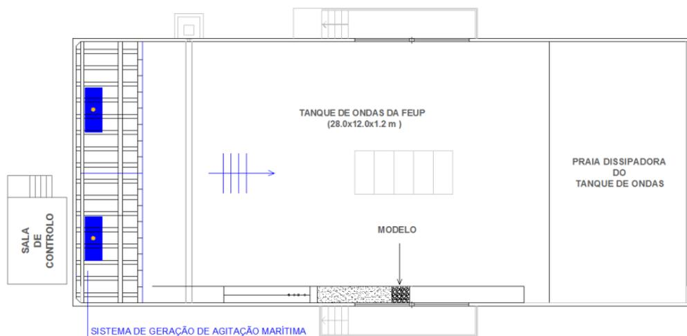
Figura 26 – Planta do tanque de ondas com canal (Bessa, 2012).
