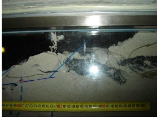
Figura A.1.1 – Disposição dos tubos geossintéticos de menores dimensões na camada inferior da estrutura
