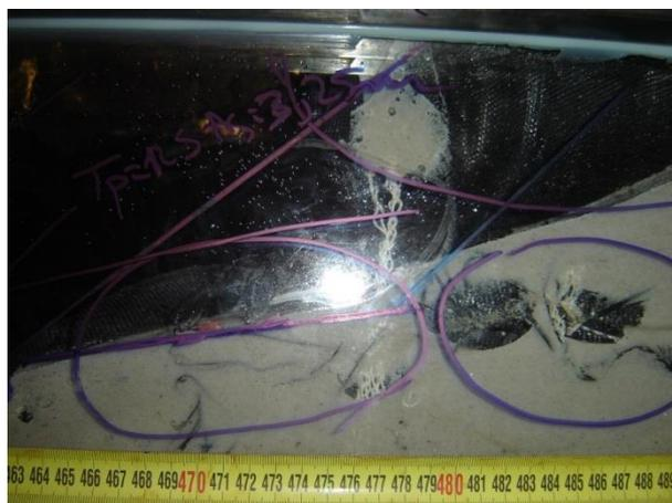
Figura A.7.3 – Perfil transversal da estrutura com o 1º volume de areia erodido
