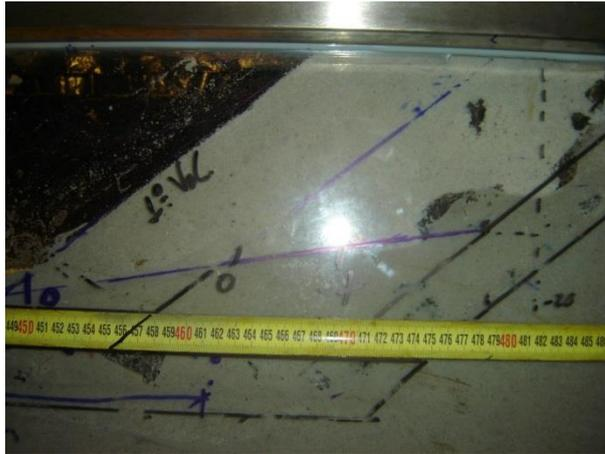
Figura B.2.2 – Disposição da camada de areia correspondente ao 1º volume e da estrutura
