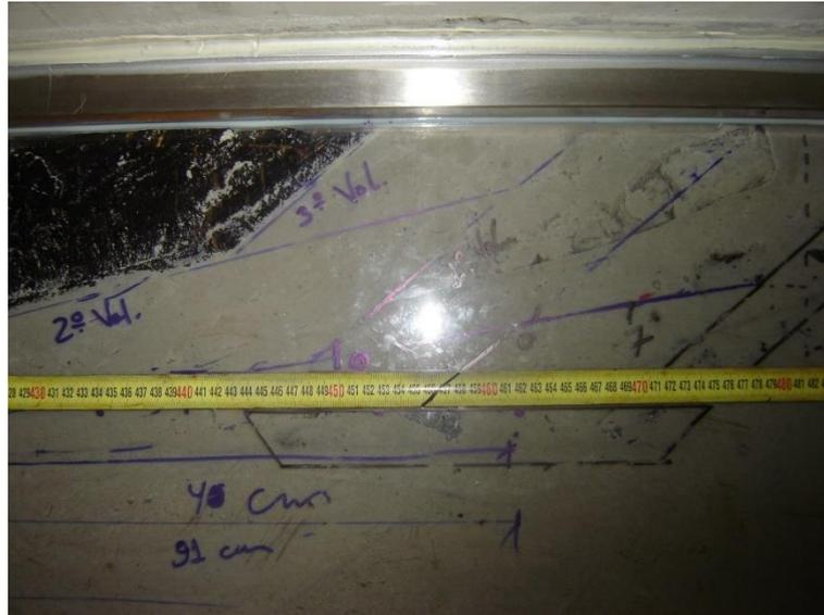
Figura 50 – Disposição dos 3 volumes de areia no ensaio B.8
