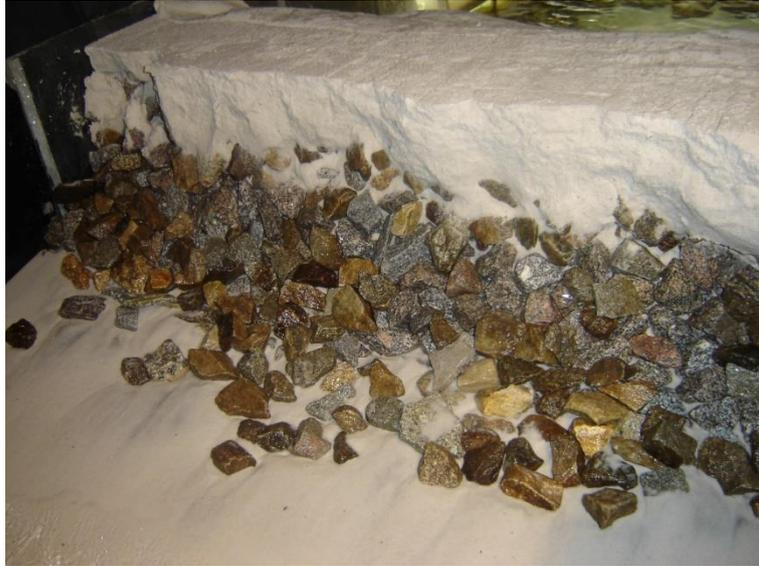
Figura 53 – Estrutura em 1º plano. Rotura da estrutura aderente. Ensaio B.9.
