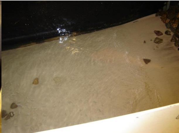
Figura B.4.4 – Deslocamentos máximos dos blocos de enrocamento causados pela instabilidade
