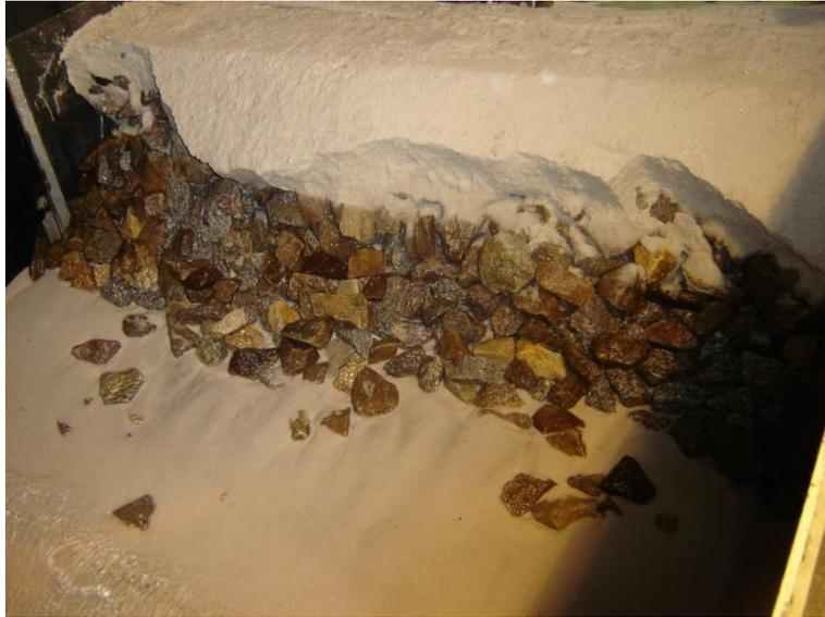
Figura 45 – Blocos de enrocamento fora da sua posição inicial. Ensaio B.4.
