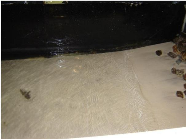
Figura B.9.11 – Exemplo de deslocamento substancial de blocos de enrocamento
