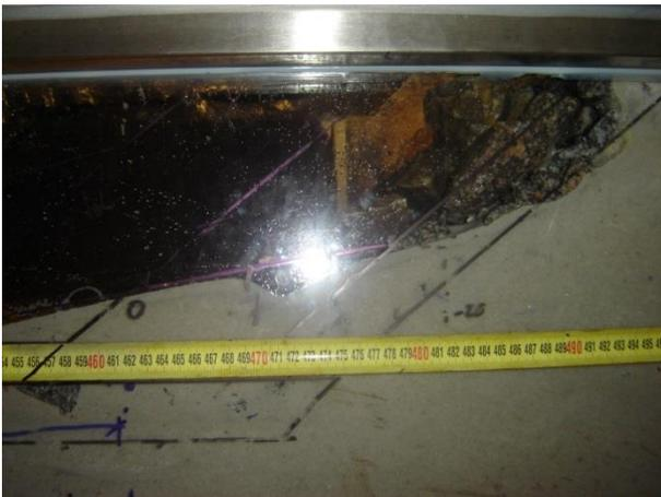
Figura B.4.5 – Erosão do 1º volume de areia após o 1º ciclo
