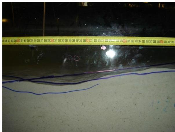
Figura A.4.3 – Erosão à profundidade aproximada de 12 cm no final do 2º ciclo
