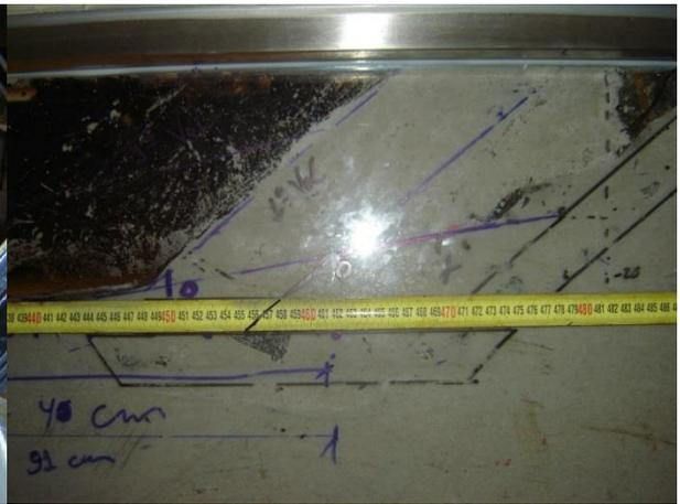
Figura B.3.2 – Disposição da estrutura e do 1º volume de areia na zona da base do talude
