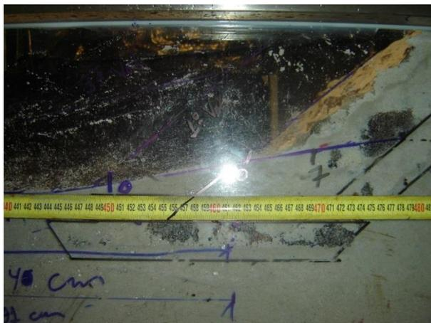
Figura B.1.3 – Perfil transversal com destaque para a zona da base do talude antes do ensaio
