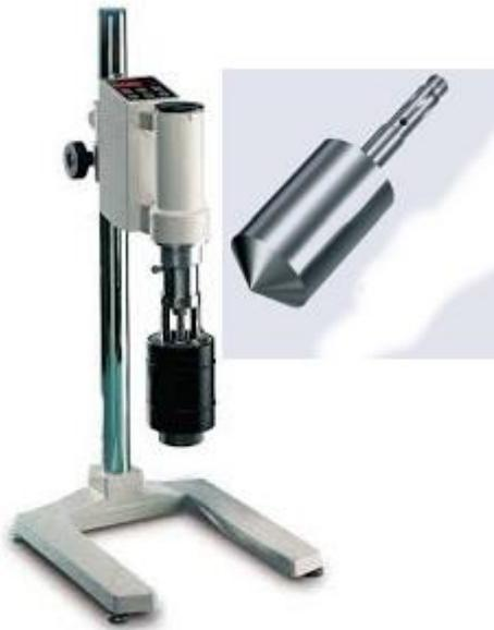
**Figura 13: Viscosímetro Thermo Haake VT500 com a respetiva sonda utilizada neste trabalho.(63)**
