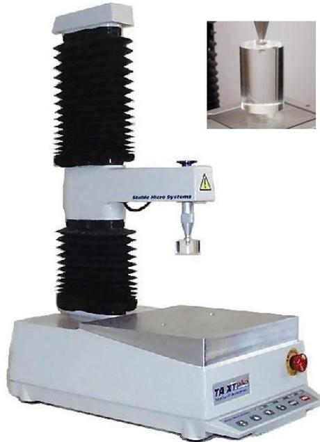
**Figura 14: Texturómetro Stable Micro Systems TA-XT2i com a sonda utilizada nos ensaios deste trabalho.(64)**
