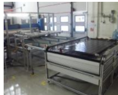
Figura 19 Saída da máquina de soldadura e máquina de estanqueidade
