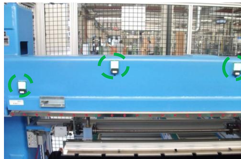
Figura 26 Sensores de posicionamento da chapa na máquina de soldar
