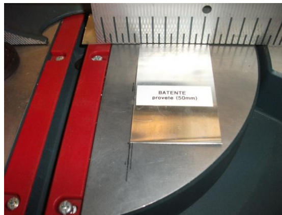
Figura 34 Batente implementado na serra elétrica
