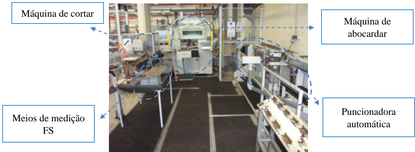
Figura 13 Célula Header Pipes
