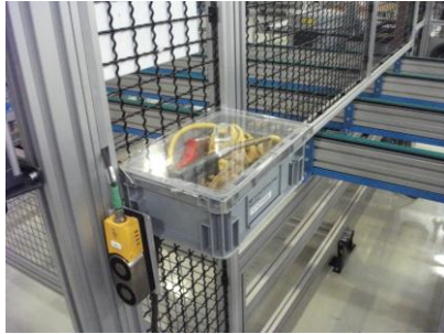
Figura 35 Caixa com ferramentas para realização de setups na célula FS
