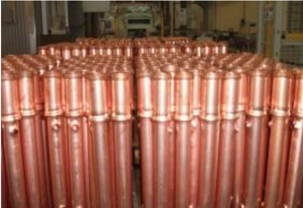
Figura 10 Abocardado nos header pipes
