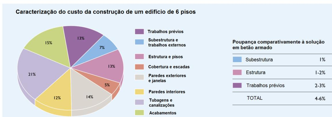
Figura 2.14 - Diminuição dos custos de construção de um edifício de seis pisos no Reino Unido (Lawson, M., 2009)
