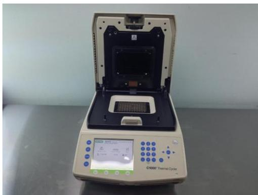
**Figura 16** – Termociclador (C1000) e módulo ótico de PCR em Tempo Real (CFX96).
